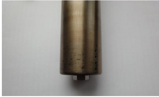
圖 4.7 第二種模具鎖附於超音波放大器底端
