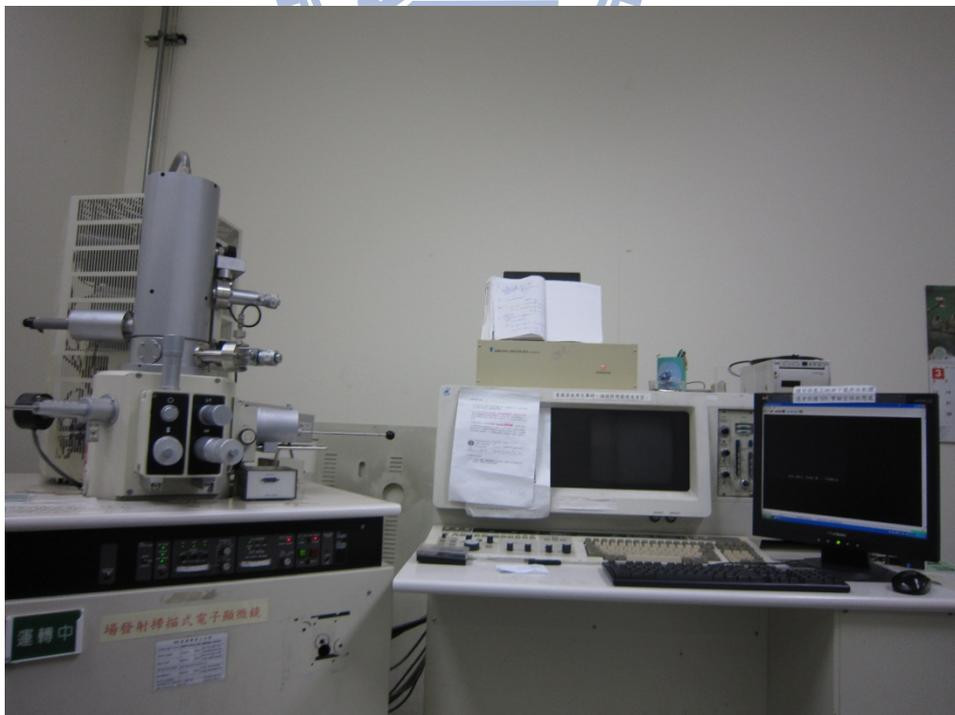
圖 3-15 掃描式電子顯微鏡
