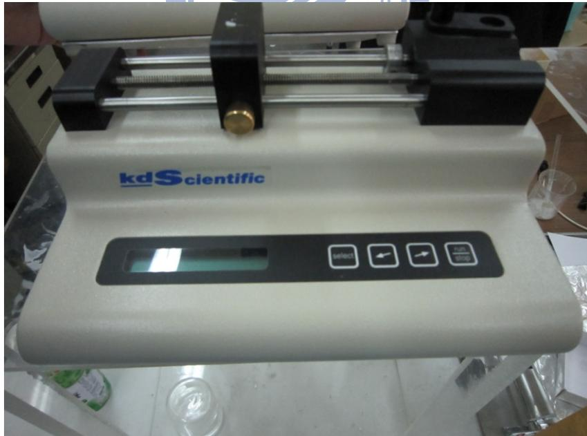
圖 3-8 注射幫浦推進器
