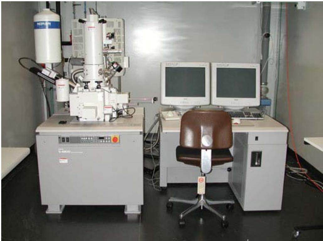
圖 3.18 掃描式電子顯微鏡
