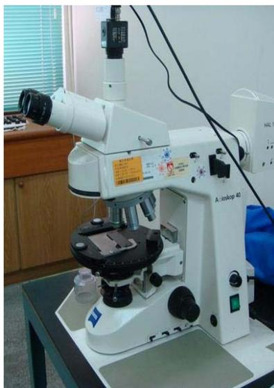
圖 3.16 光學顯微鏡 ZEISS Axioskop 40
