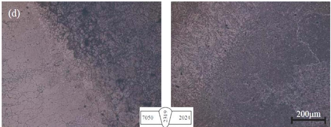
圖 4.6 d 7050/2024-2319-T6 異質銲接銲後金相顯微組織圖
