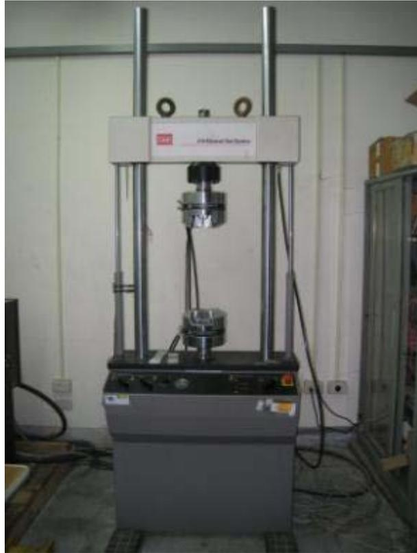
圖 3.12 拉伸試驗機 MTS810 Material Test System
