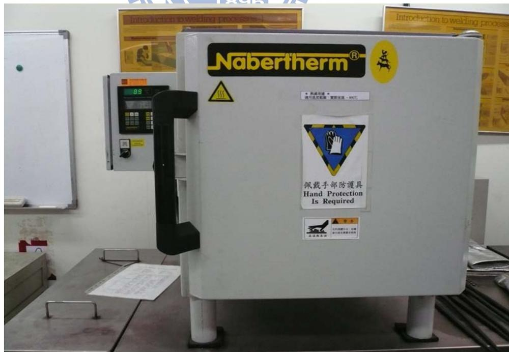
圖 3.7 Nabertherm 熱處理爐
