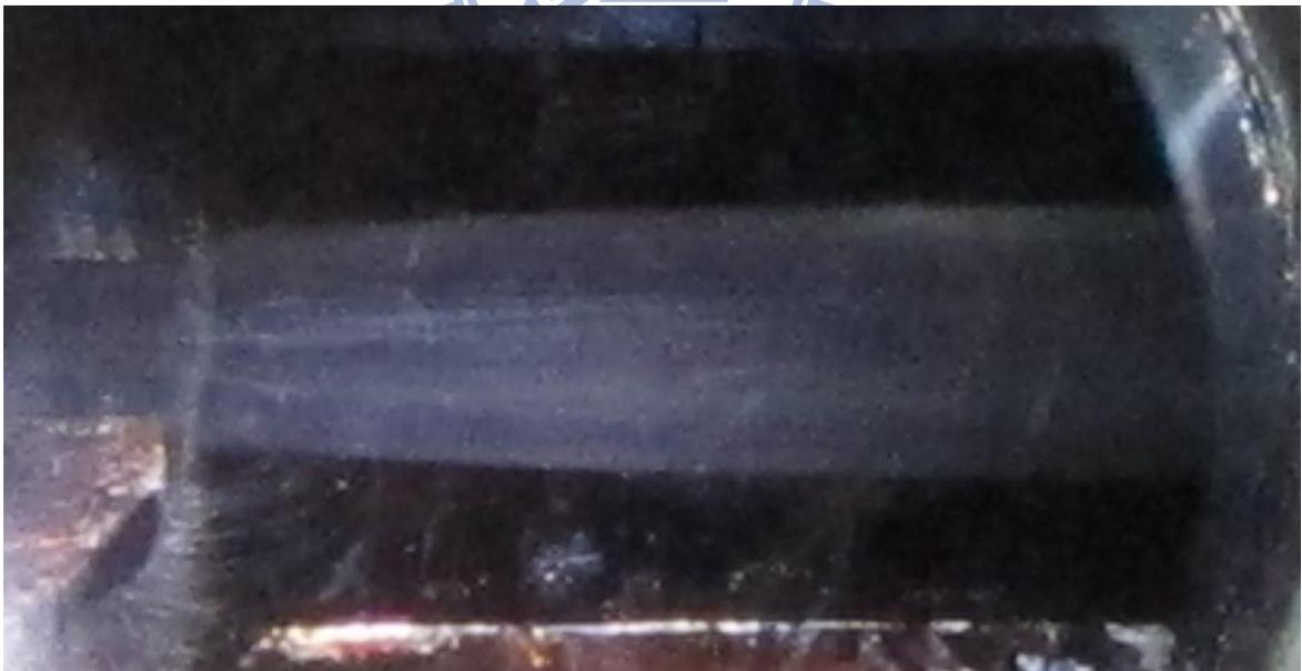
圖 4.47 擠出溫度 PC290°C、PMMA280°C，流速 5cm/s 結果圖
