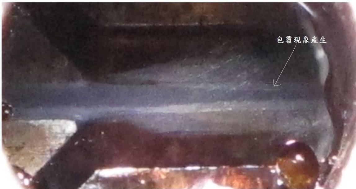
圖 4.9 擠出溫度 280°C，速度 2cm/s 結果圖
