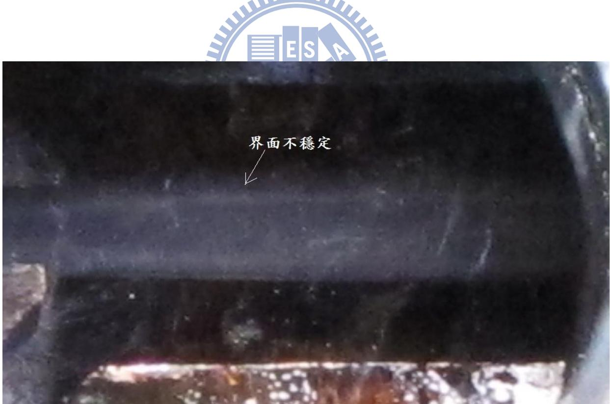
圖 4.19 擠出溫度 290°C，速度 4cm/s 結果圖
