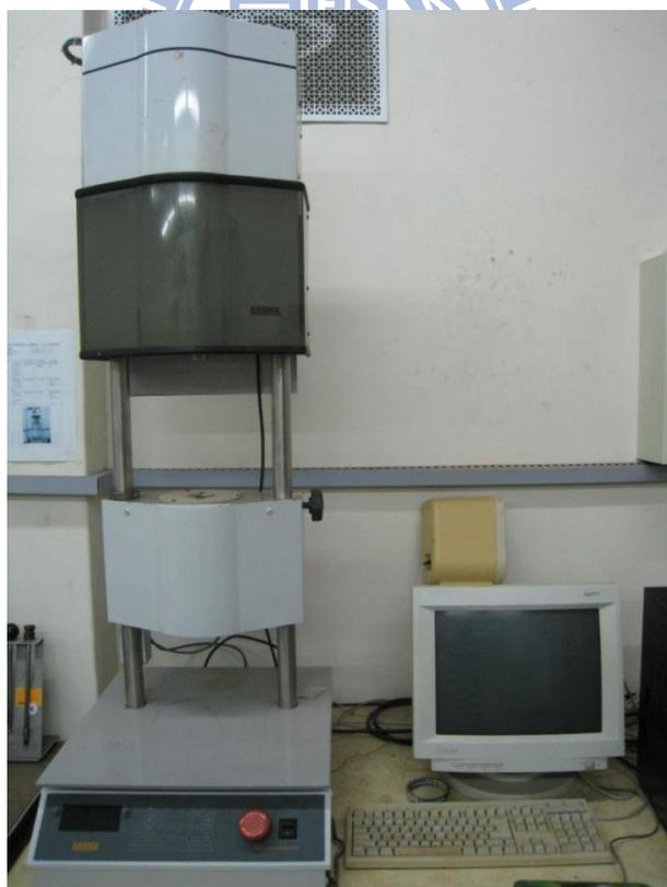
圖 3.13 毛細管流變儀
