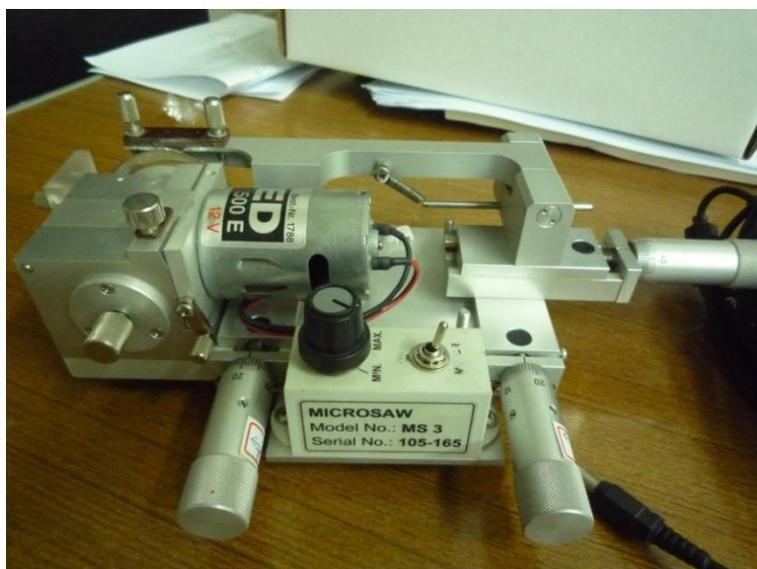
圖 3.5 鑽石刀切割機
