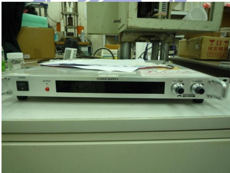
圖 3.6 高壓直流電源供應器
