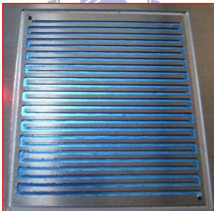
圖 4.6 齊發齊收與單發齊收模式流道內有水之實驗照片
