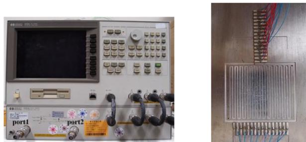
圖 4.41 插入損失量測實驗架構
