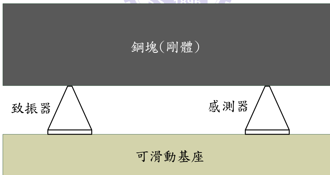
圖 4.6 可滑動基座量測示意圖
