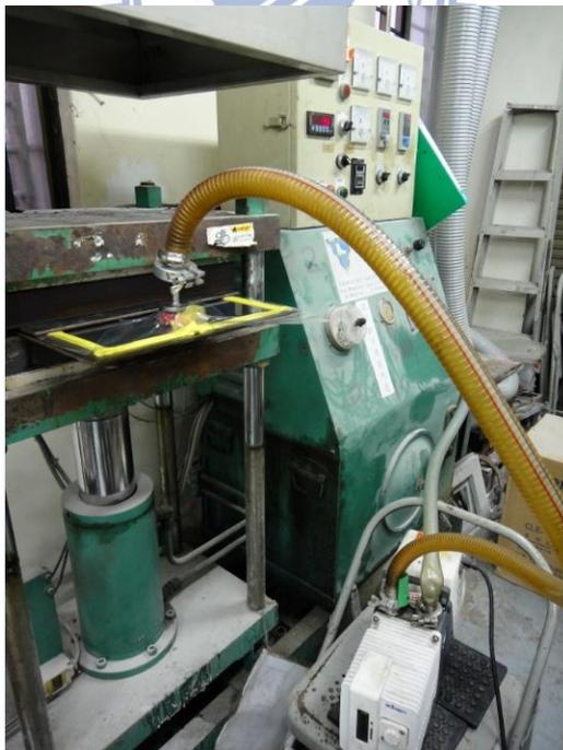
圖 4.4 使用熱壓製程及真空幫浦黏合壓電纖維與下指叉電極
