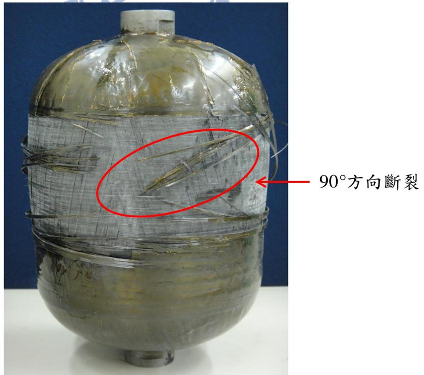
圖 3.41 AE-FRP-14 爆破後照片
