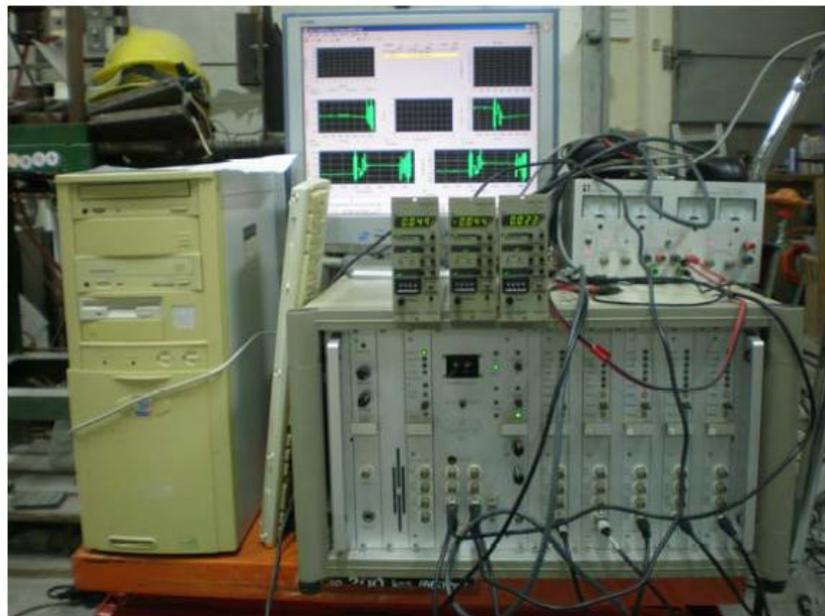
圖 3.5 音洩量測系統 Vallen AMS3 實體照片
