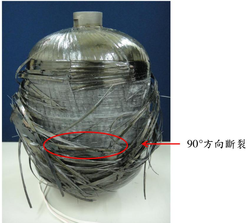
圖 3.40 AE-FRP-12 爆破後照片
