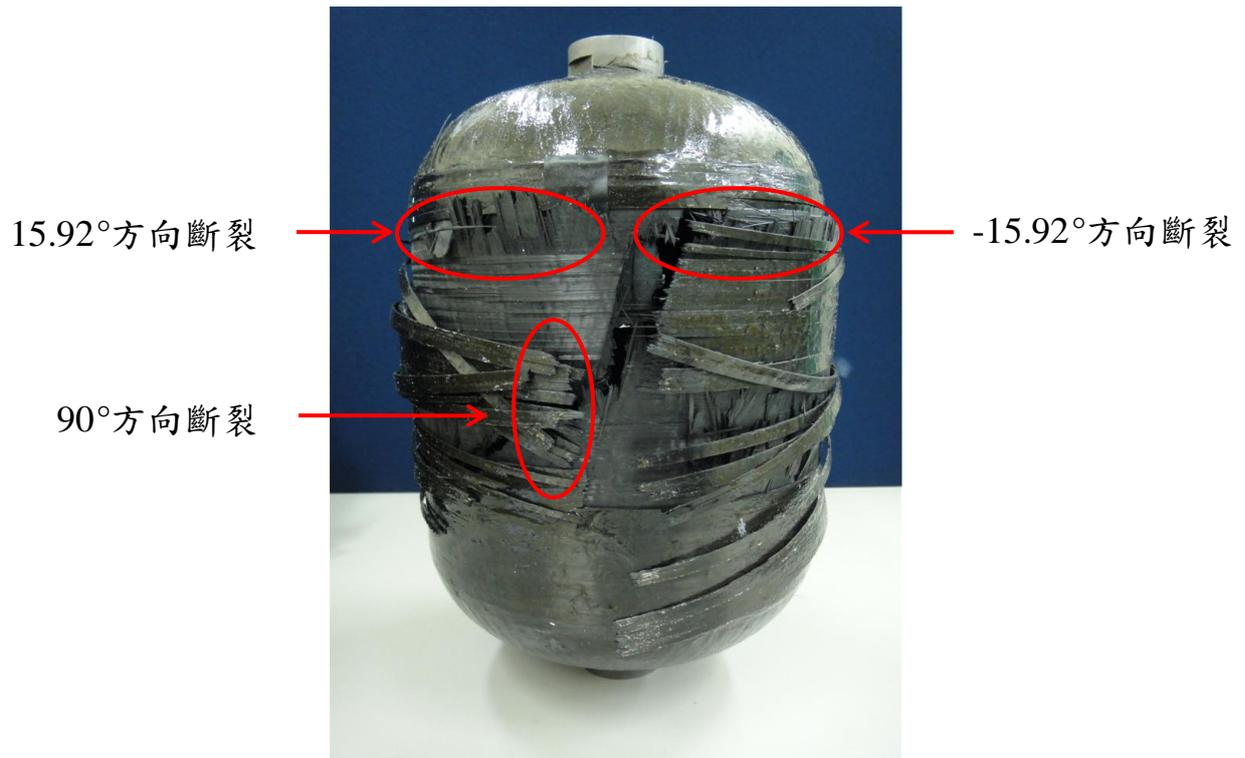
圖 3.44 AE-FRP-09 爆破後照片
