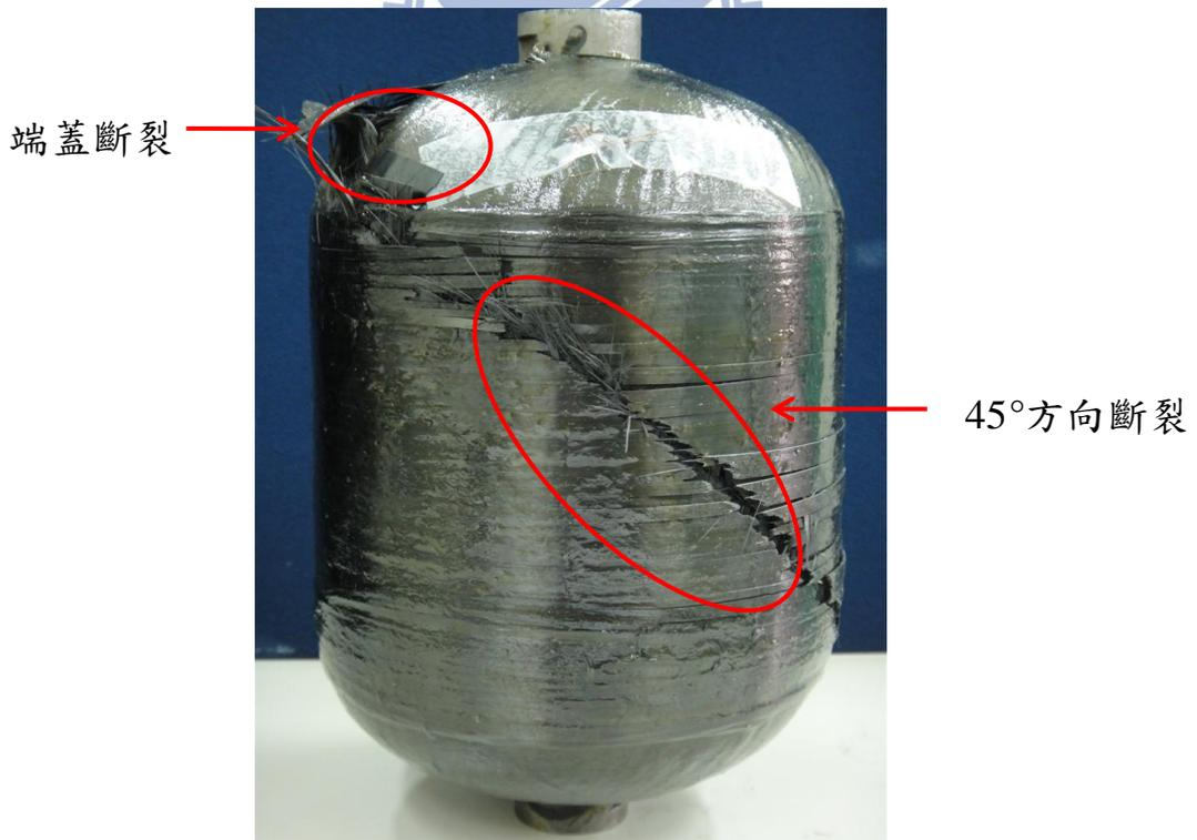
圖 3.47 AE-FRP-05 爆破後照片
