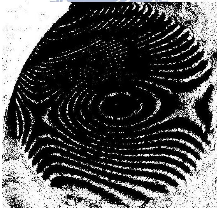
圖 3.23 以斷開消除暗紋中雜訊(白洞)的結果
