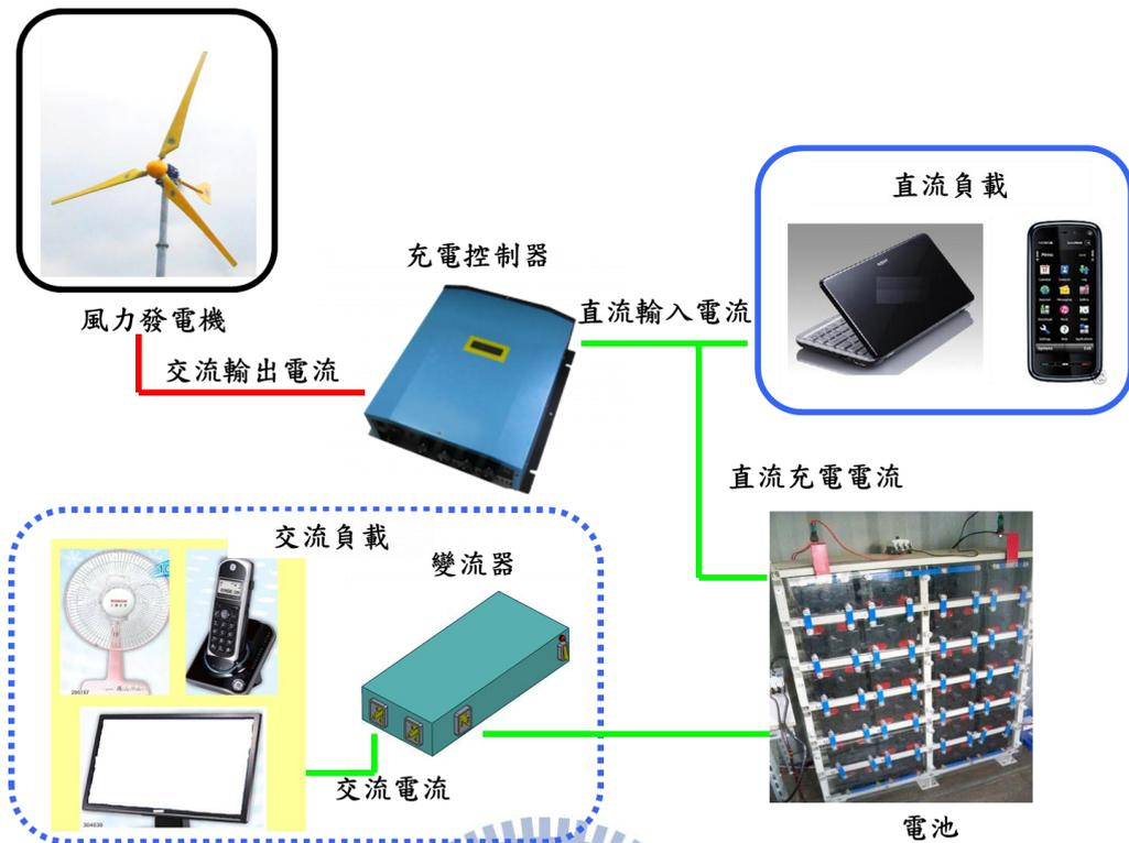
圖 2-8 獨立型風力發電系統
