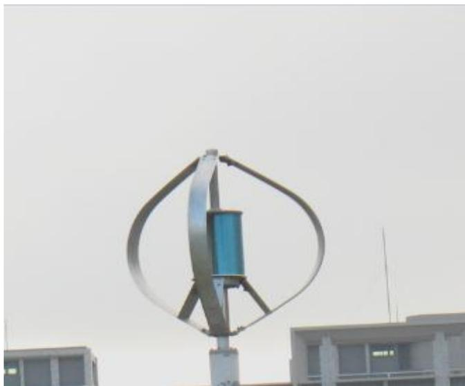
圖 2-2 垂直軸式風力發電機
