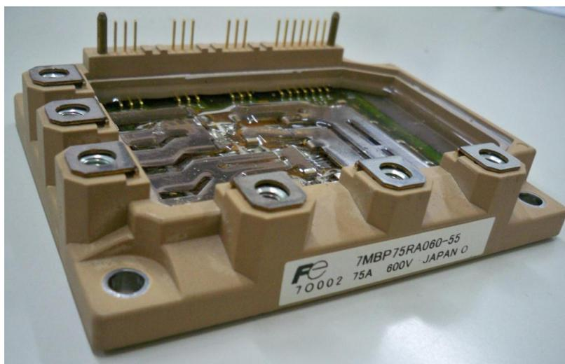
圖 4-8 7MBP75RA060 功率模組實體結構
