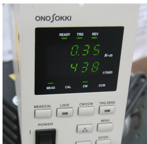
圖 5-2 轉軸扭力值與發電機轉速值
