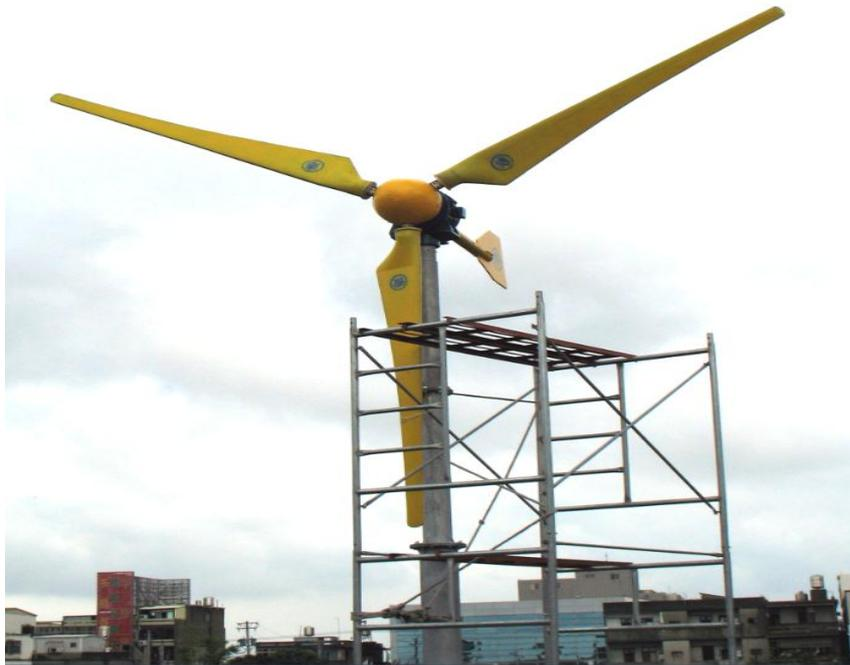
圖 2-7 5kW 風力發電機
