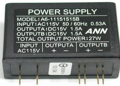
圖 4-9 交流-直流雙輸出變壓器
