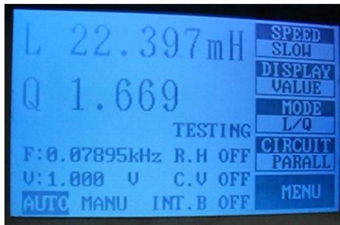
圖 5-6 轉子轉動時線電感最大值
