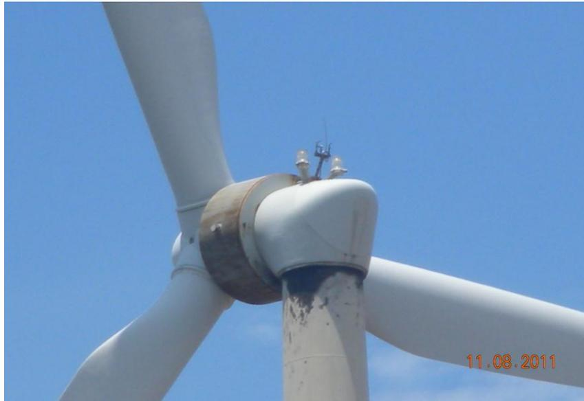
圖 2-5 直驅式大型風力發電機
