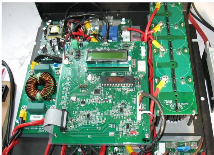
圖 2-9 小型風力發電系統控制器
