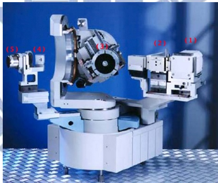
圖 3-11 本研究使用之 X 光繞射頻譜儀外觀圖
