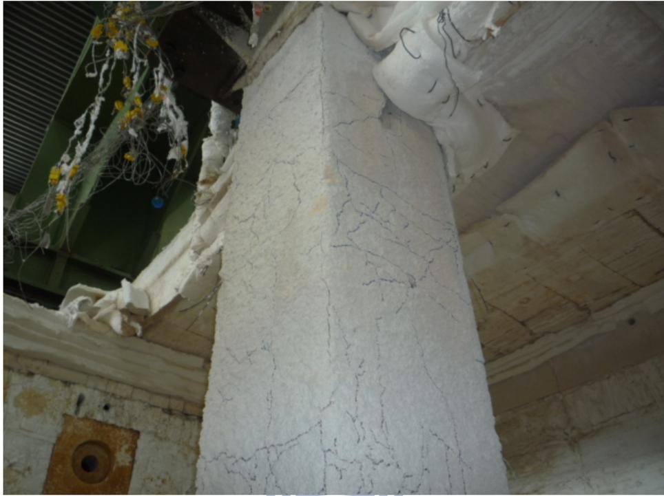
圖 4-32 試體 CFBC-1 上段試驗後防火被覆裂縫
