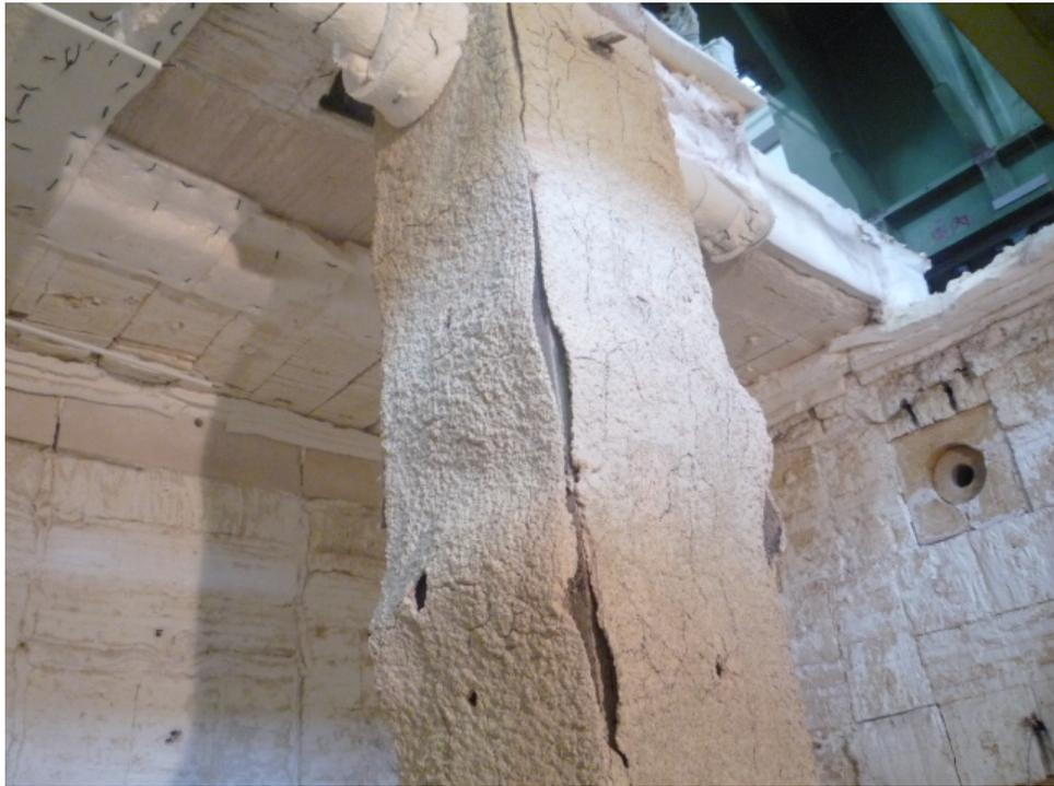
圖 4-36 試體 CFBC-2 上段試驗後防火被覆開裂
