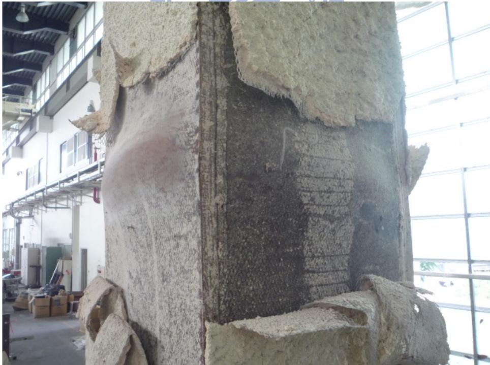
圖 4-39 試體 CFBC-2 中段試驗後局部挫屈之一(已剝除防火被覆及鋼網)
