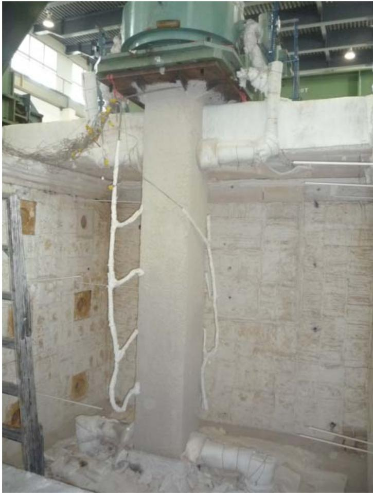
圖 3-16 現場試體設置圖
