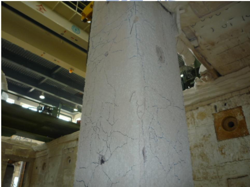
圖 4-33 試體 CFBC-1 中段試驗後防火被覆裂縫
