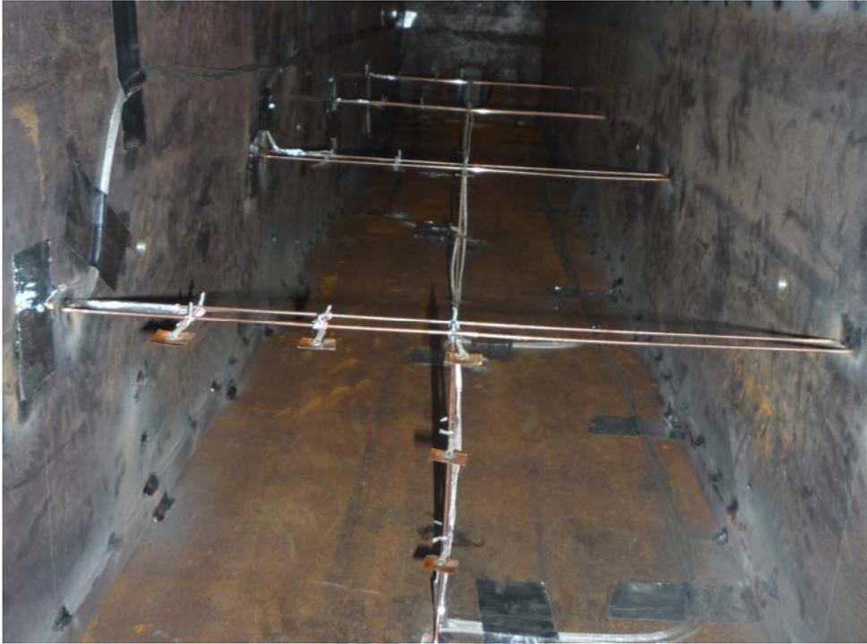
圖 3-3 CFBC 試體內部熱電偶測點安裝圖
