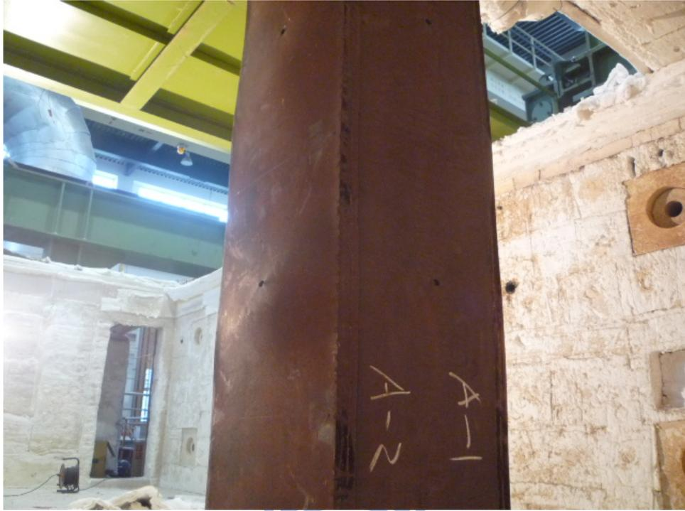
圖 4-44 試體 CFBC-3 中段局部挫屈情形
