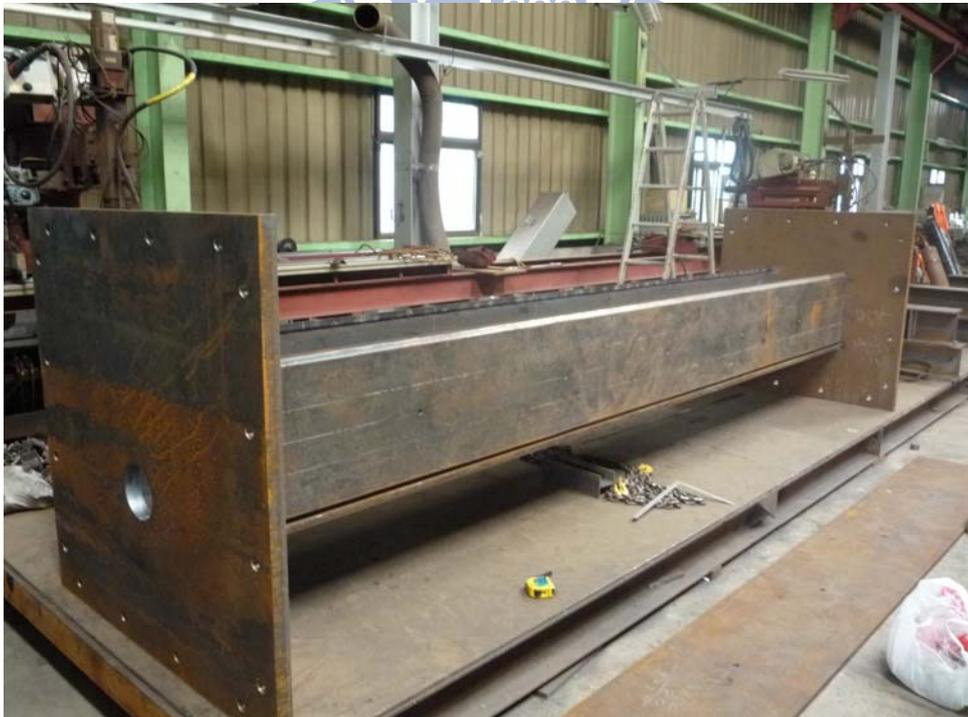
圖 3-4 箱型鋼柱施工圖
