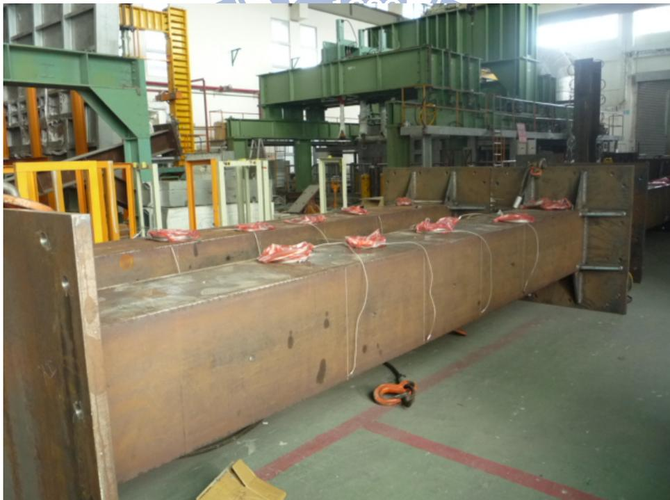
圖 3-6 CFBC 試體表面熱電偶測點安裝圖
