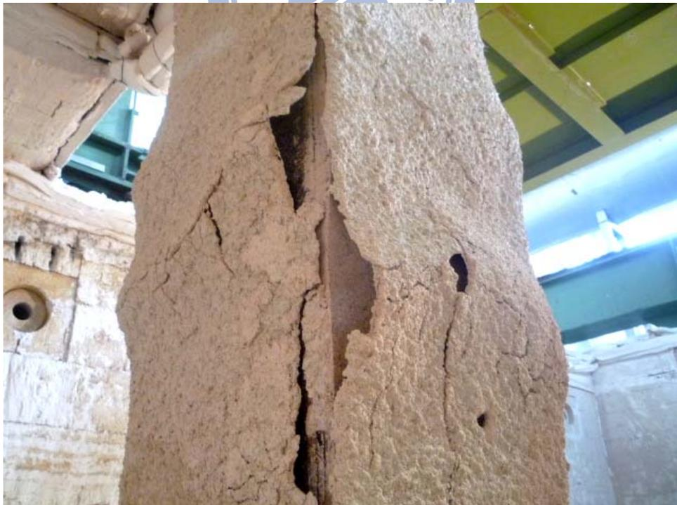
圖 4-37 試體 CFBC-2 中段試驗後防火被覆開裂
