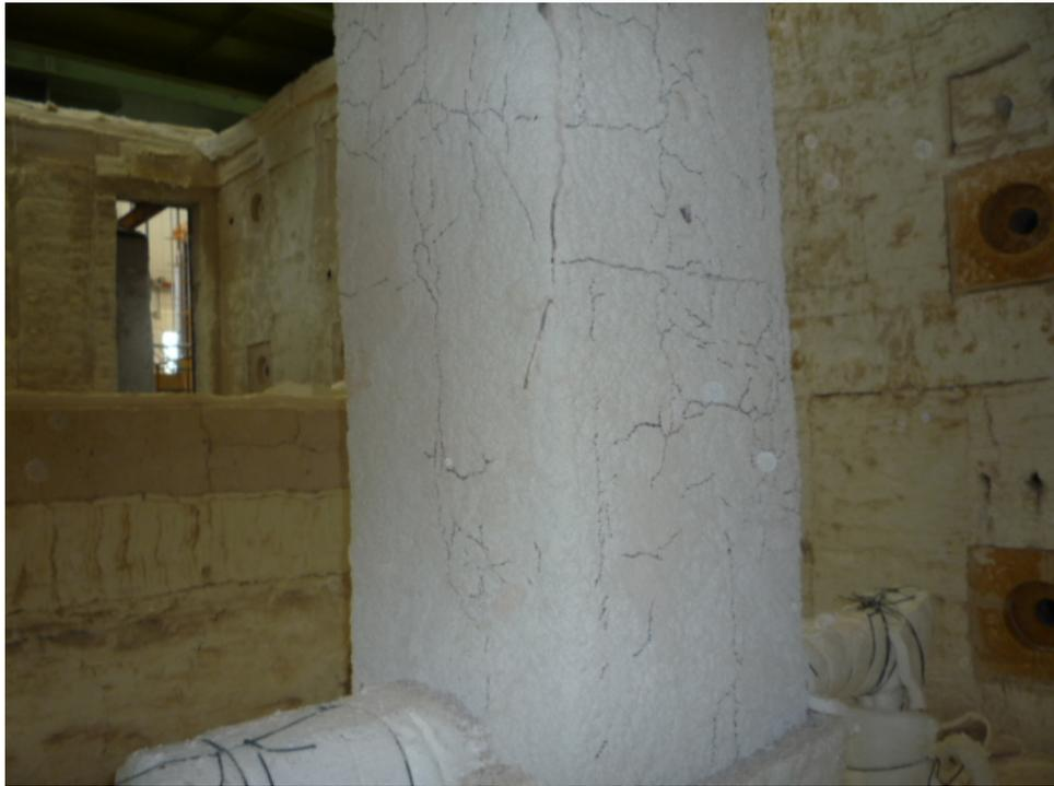
圖 4-34 試體 CFBC-1 下段試驗後防火被覆裂縫
