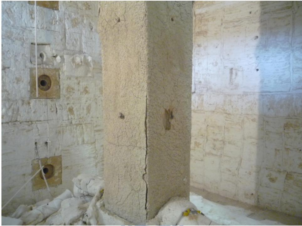
圖 4-38 試體 CFBC-2 下段試驗後防火被覆開裂
