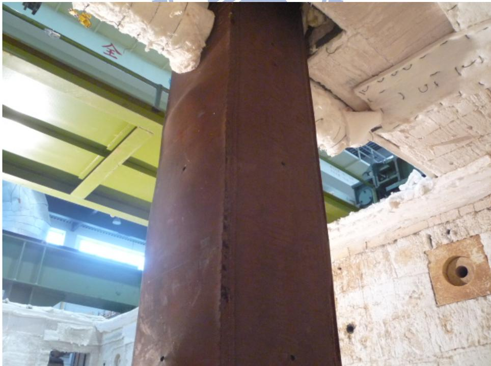
圖 4-43 試體 CFBC-3 上段局部挫屈情形
