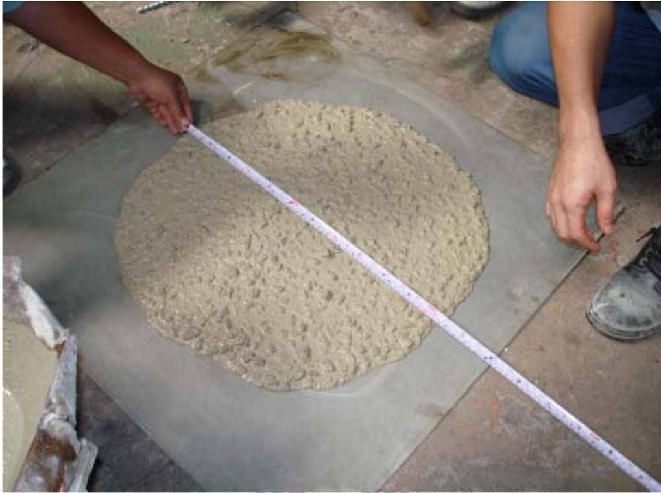
圖 3-5 自充填混凝土於灌漿前進行坍流度之量測
