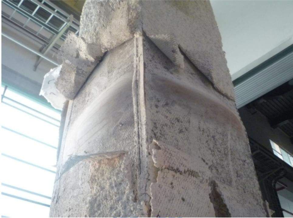
圖 4-40 試體 CFBC-2 中段試驗後局部挫屈之二(已剝除防火被覆及鋼網)
