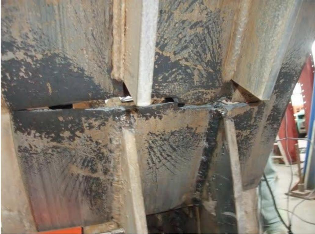
圖 4.37 試體 CP1 最終於連接板發生斷裂
