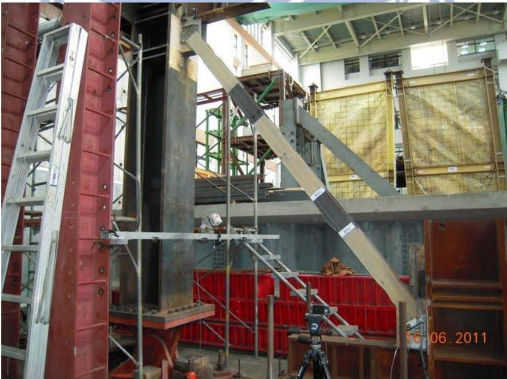
圖 4.30 試體 RS4 於 0.5% 弧度 IDA 產生整體挫屈
