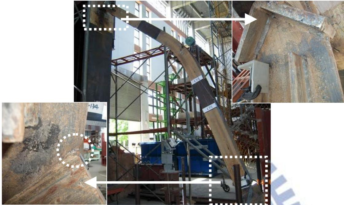
圖 4.39 試體 CP2 於 3.0% 弧度 IDA 連接板銲道產生裂縫
