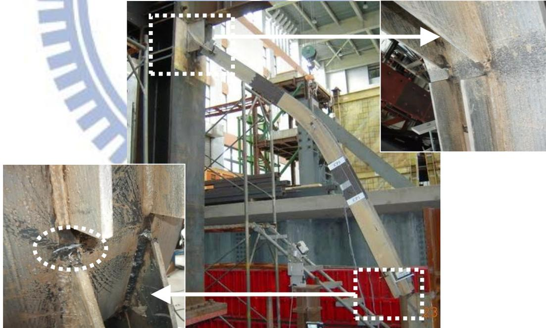
圖 4.36 試體 CP1 於 2.0% 弧度 IDA 連接板產生開裂
