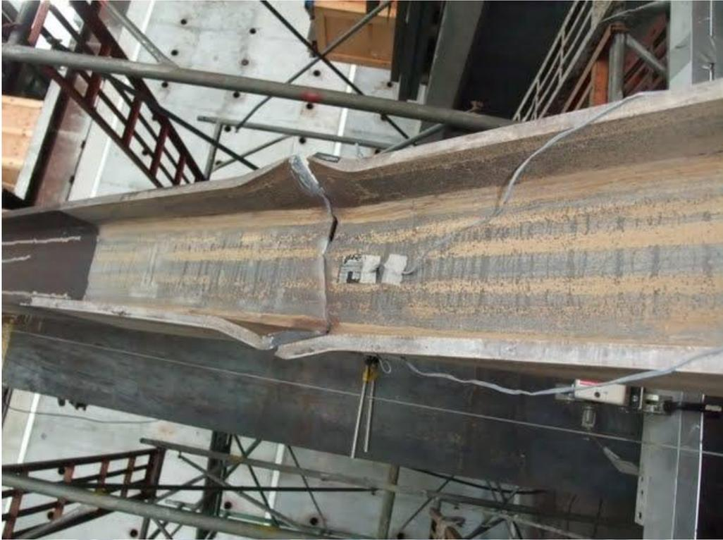
圖 4.33 試體 RS4 最終於斜撐中點斷裂
