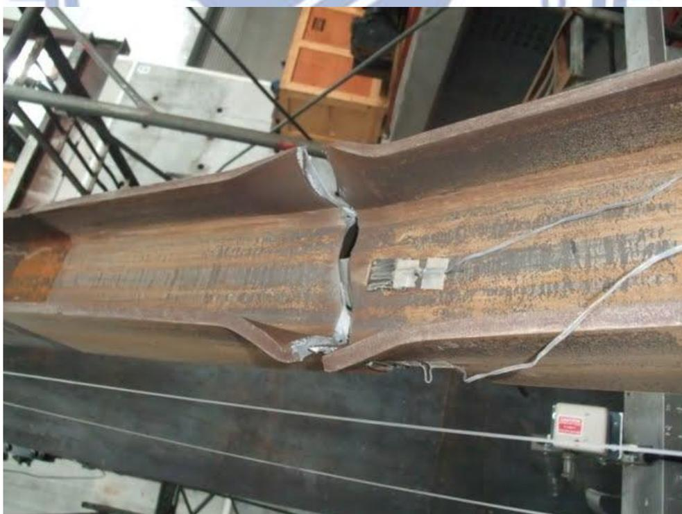
圖 4.24 試體 RS2 最終於斜撐中點斷裂
