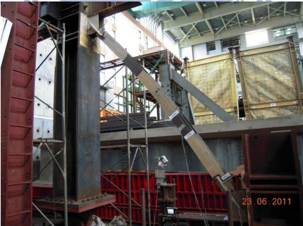
圖 4.34 試體 CP1 於 0.5% 弧度 IDA 產生整體挫屈
