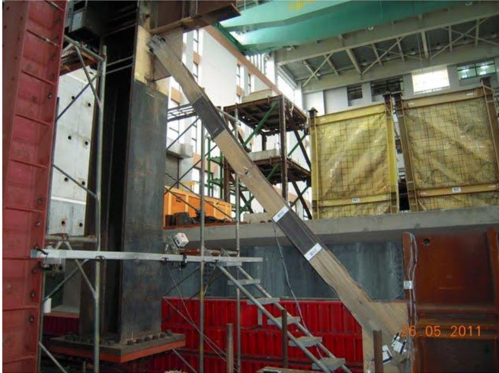
圖 4.21 試體 RS2 於 0.75% 弧度 IDA 產生整體挫屈
