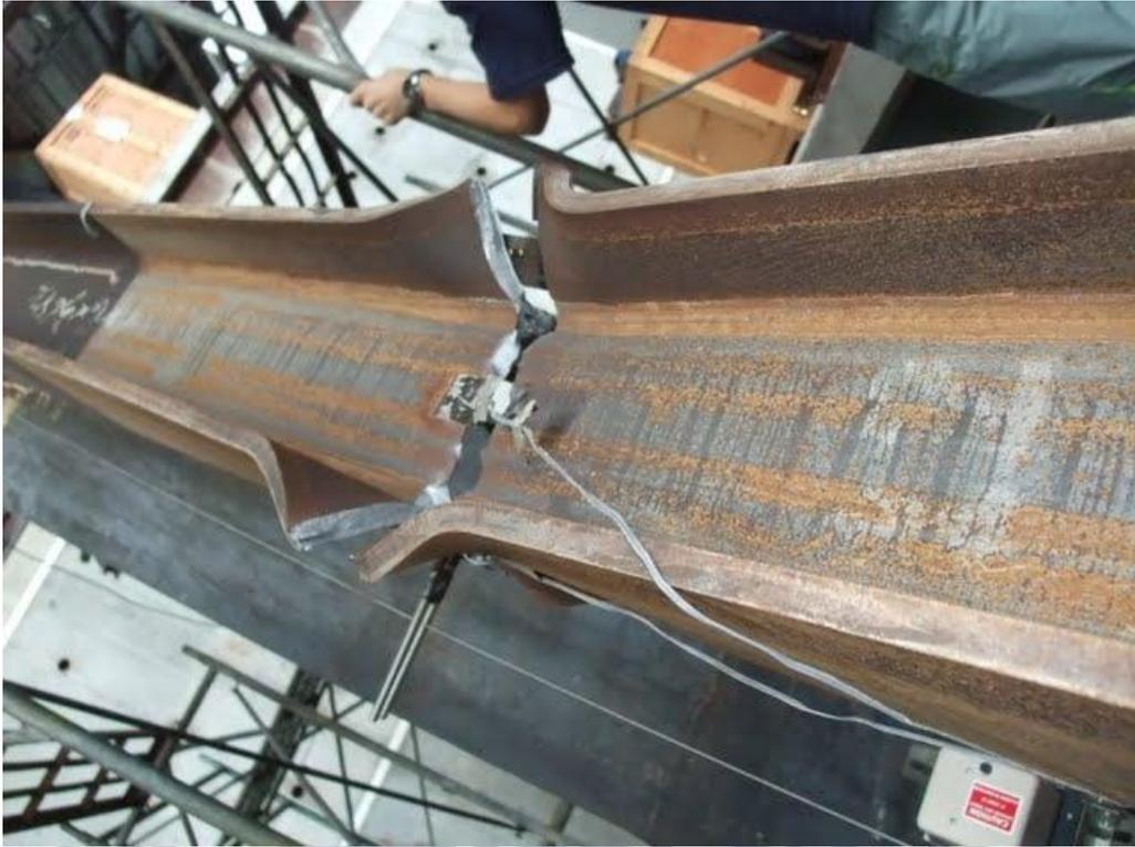
圖 4.29 試體 RS3 最終於斜撐中點斷裂
