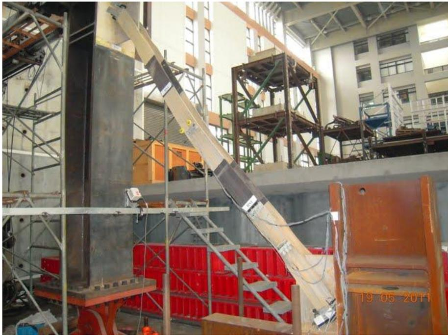
圖 4.17 試體 RS1 於 0.75% 弧度 IDA 產生整體挫屈
