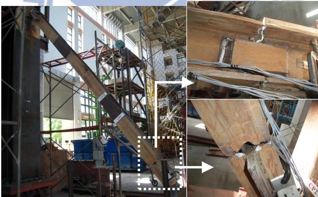
圖 4.40 試體 CP2 最終於斜撐翼板與連接板接合處發生斷裂
