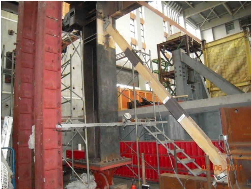
圖 4.25 試體 RS3 於 0.5% 弧度 IDA 產生整體挫屈
