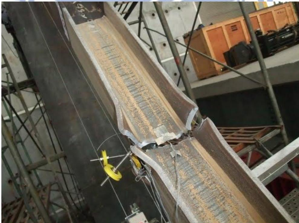
圖 4.20 試體 RS1 最終於斜撐中點斷裂
