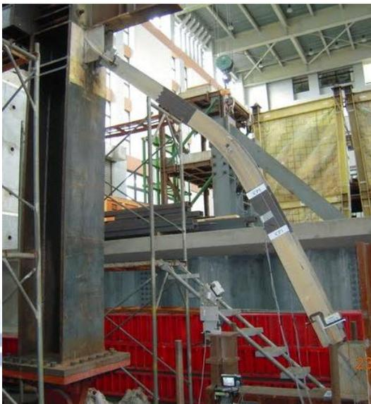
圖 5.9 試體 CP1 斜撐行為與分析結果比較(2.0% 弧度 IDA)
