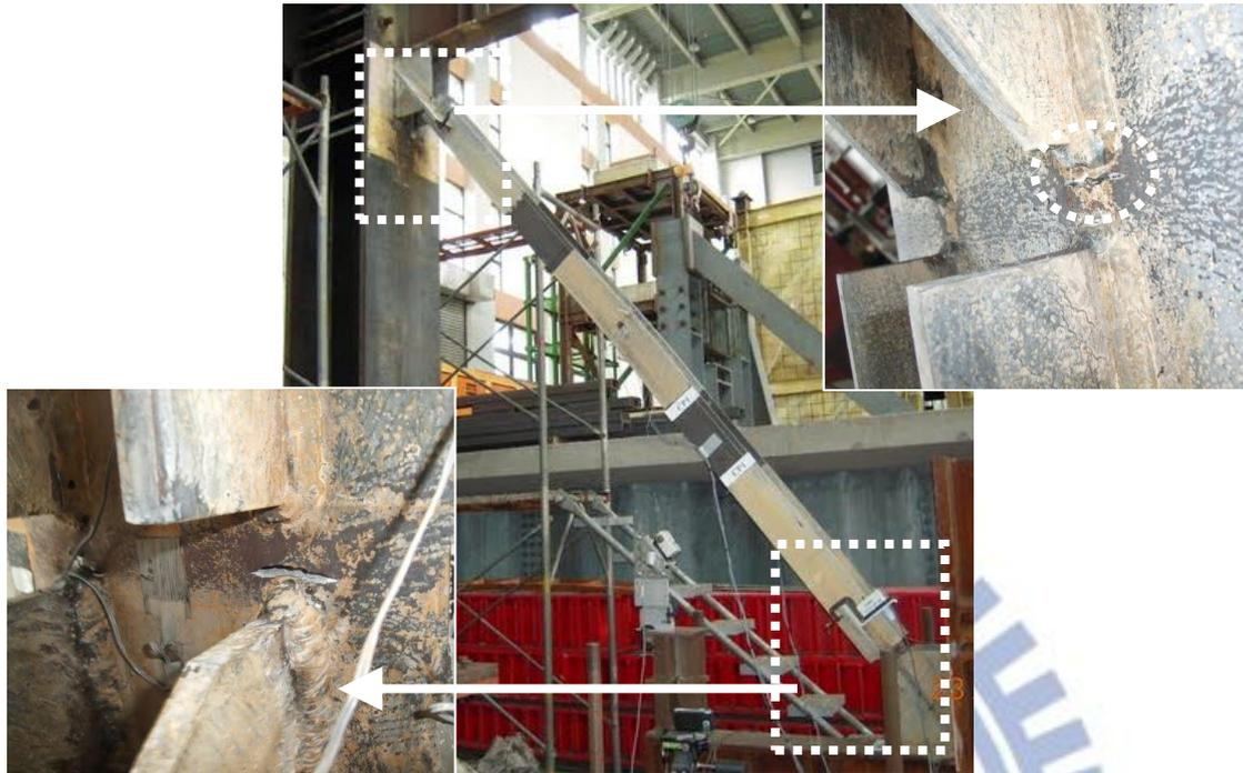
圖 4.35 試體 CP1 於 1.5%(T) 弧度 IDA 連接板銲道產生裂縫
