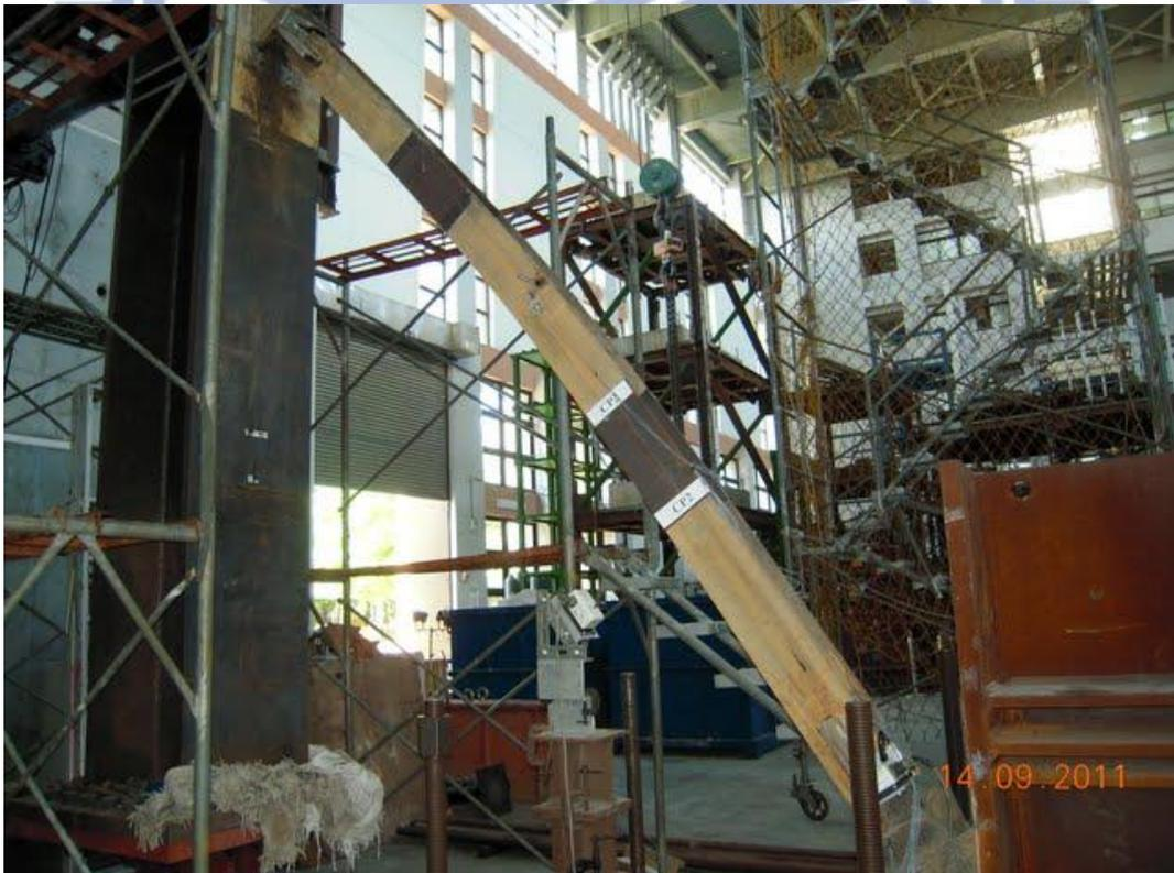
圖 4.38 試體 CP2 於 0.5% 弧度 IDA 產生整體挫屈
