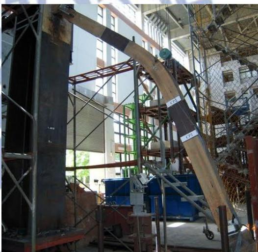
圖 5.10 試體 CP2 斜撐行為與分析結果比較(3.0% 弧度 IDA)
