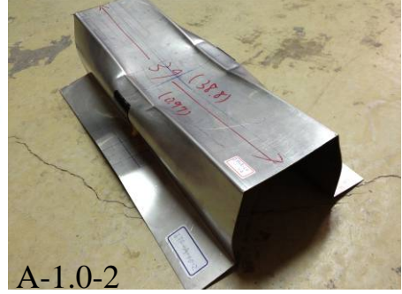
圖 4.18 A-1.0 之分析模型與試體實驗變形圖
