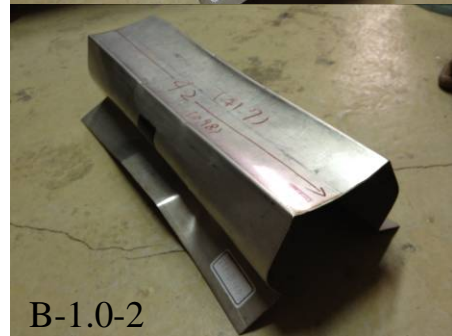
圖 4.21 B-1.0 之分析模型與試體實驗變形圖
