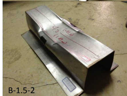
圖 4.22 B-1.5 之分析模型與試體實驗變形圖
