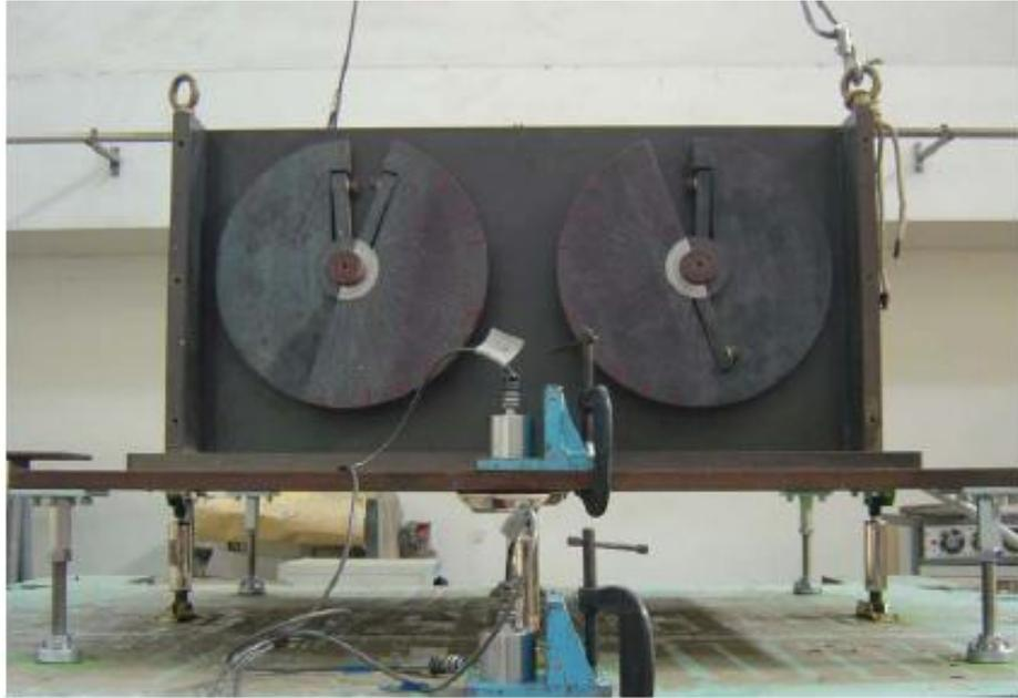
圖 1.8 液流阻尼器於基座減振性能照片【16】
