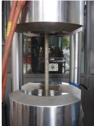
圖 2.20 實驗室-鋼棒抗拉試驗
