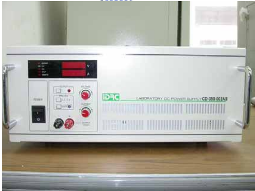
圖 3.2 直流電源供應器
