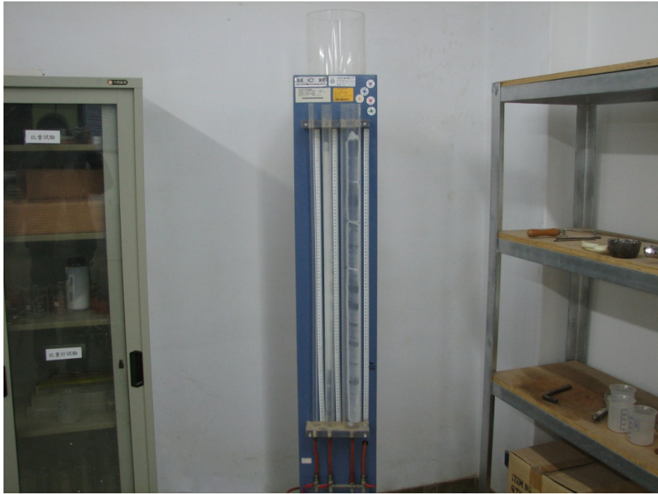
圖 C.1 定壓力之水量供給設備相片
