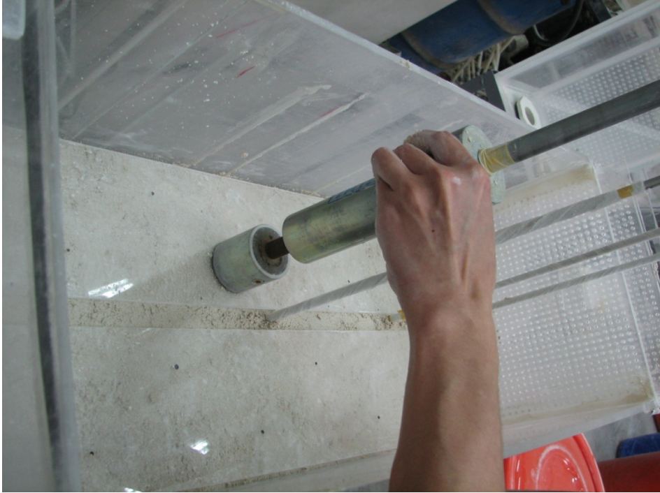
圖 3.4 岸壁土體分層夯實過程
