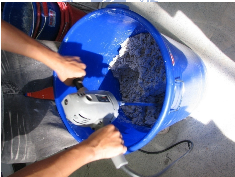
圖 3.3 試驗材料拌合過程
