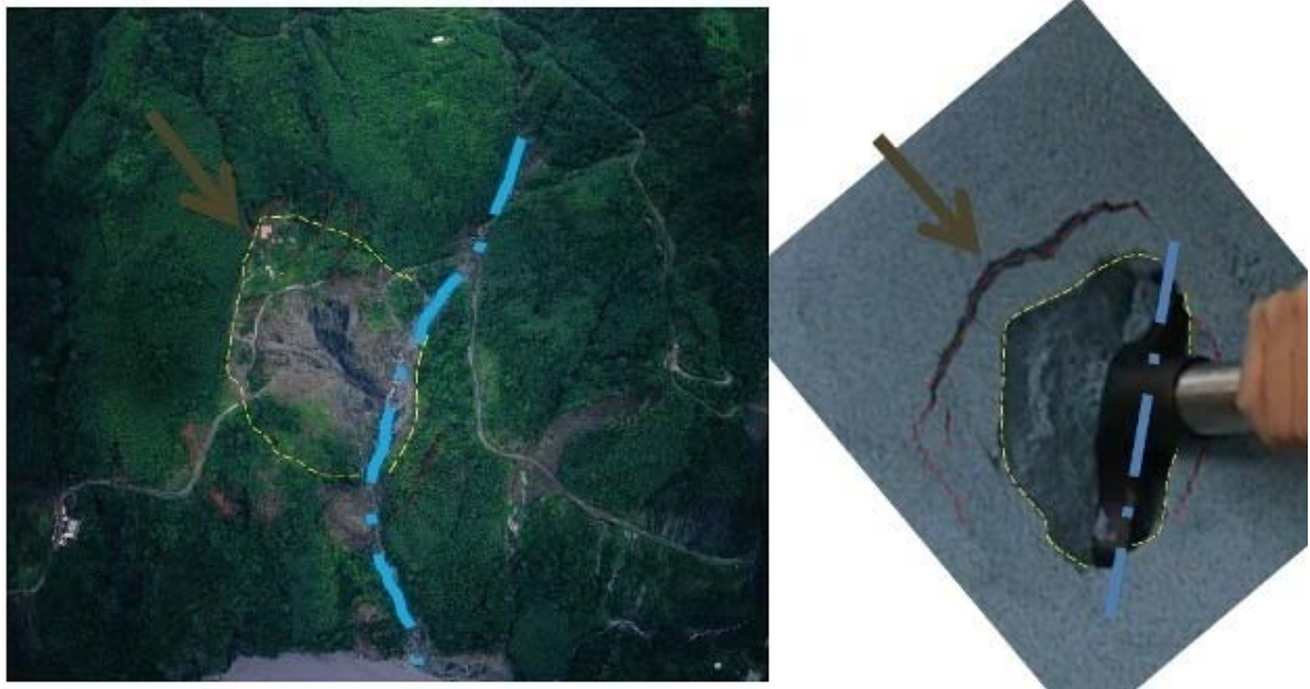
圖 1.1 現地崩塌照片與模型試驗比對
