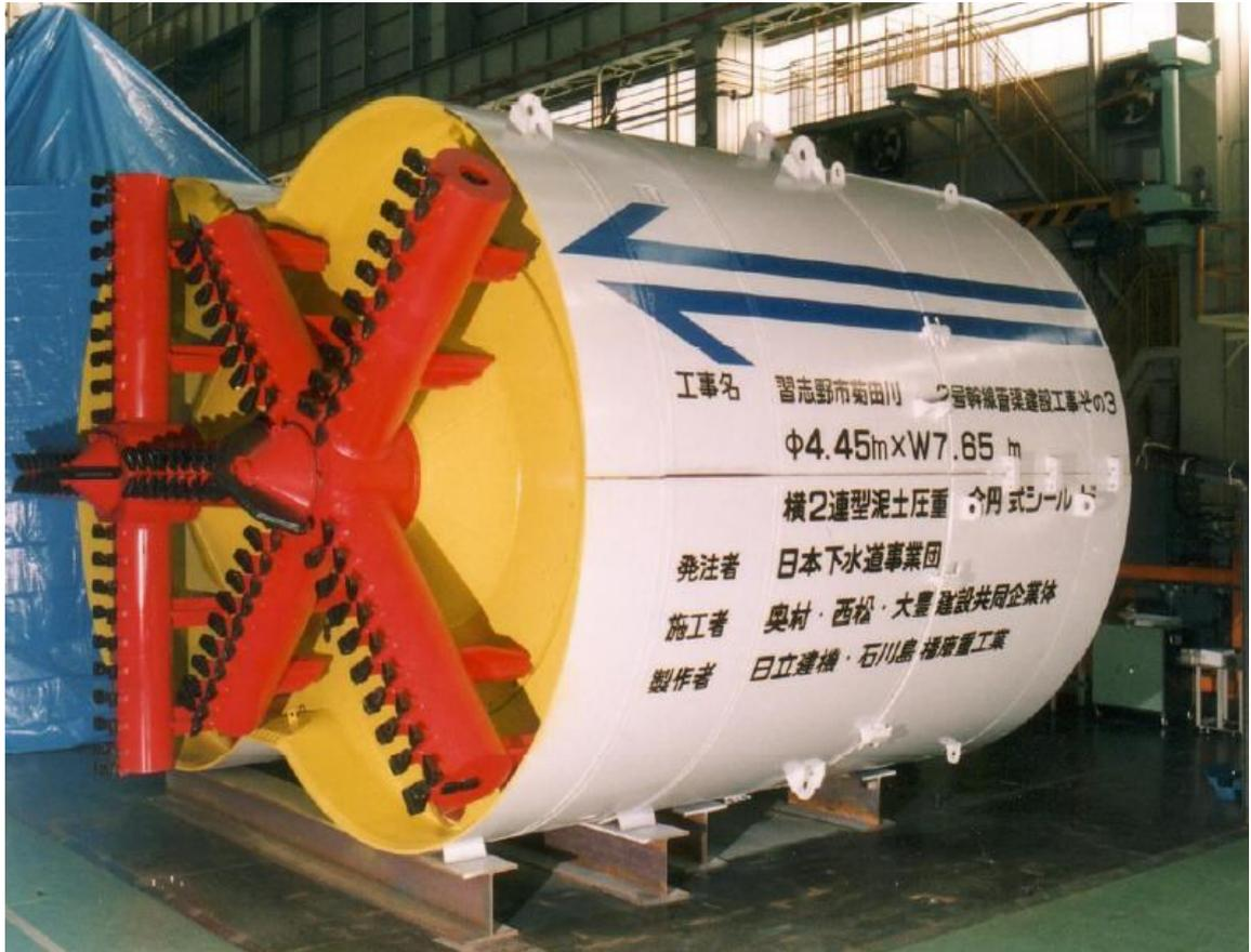
圖 3-1 千葉縣習志野市菊田川 2 號幹線管渠建設工程使用之 DOT 潛盾機
