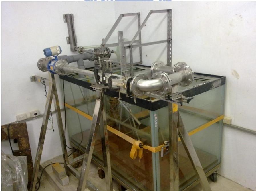
圖 3—2 多功能沖蝕儀-可變角度射流沖刷試驗設備照片
