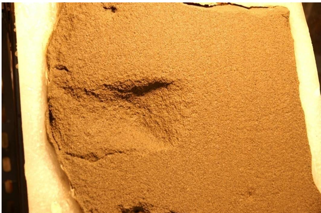
圖 4-40 沖蝕坑遭試體邊界效應破壞照片
