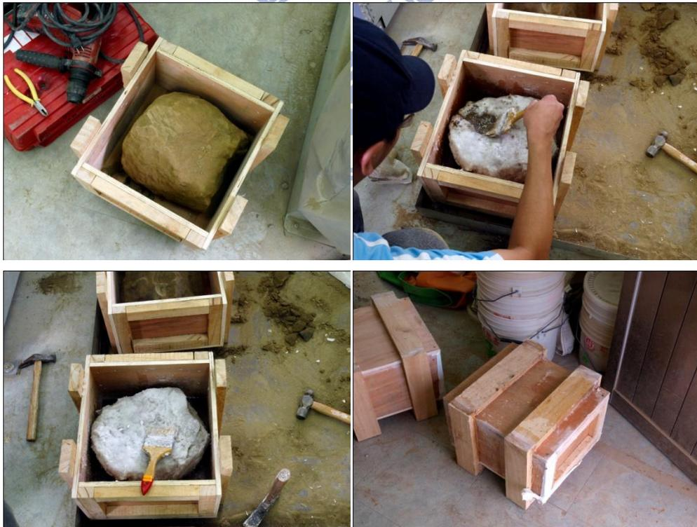
圖 4-3 (a)置入岩塊 (b)岩塊封蠟
