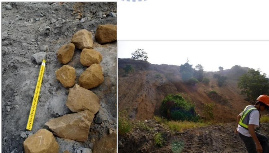
圖 4-1 (a)挑選過之岩塊 (b)取樣現場地質狀況
