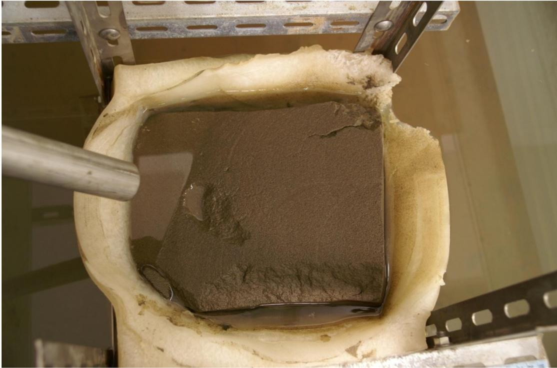
圖 4—43 固定試體之白蠟熔化使試體變位
