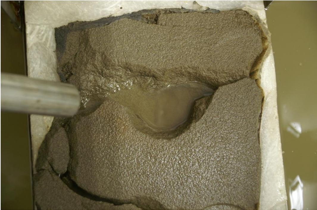
圖 4—41 沖蝕坑沿層面破壞
