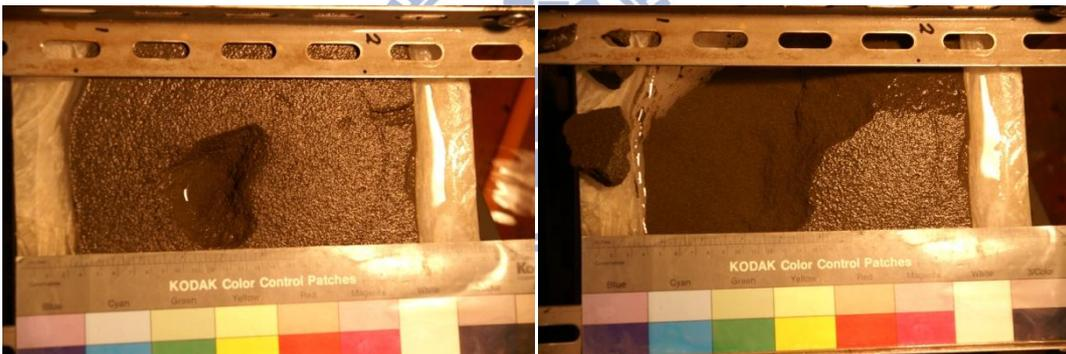
圖 4—42 (a)沖蝕坑沿層面破壞前 (b)沖蝕坑沿層面破壞後
