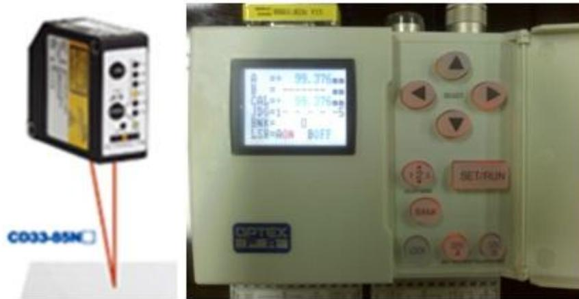
圖 3-9 雷射位移計與雷射位移數據擷取放大器
