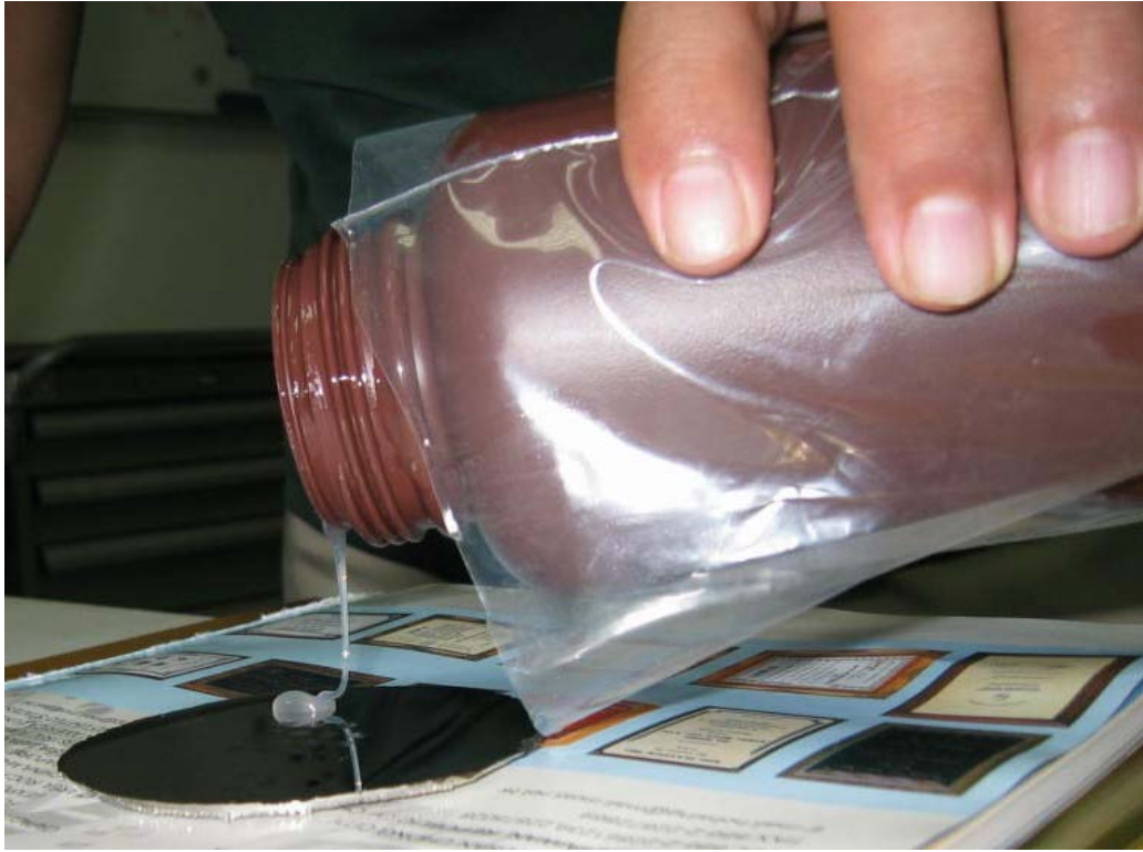
【圖 3-3】手動紫外光壓印固化轉寫成形步驟 1：
