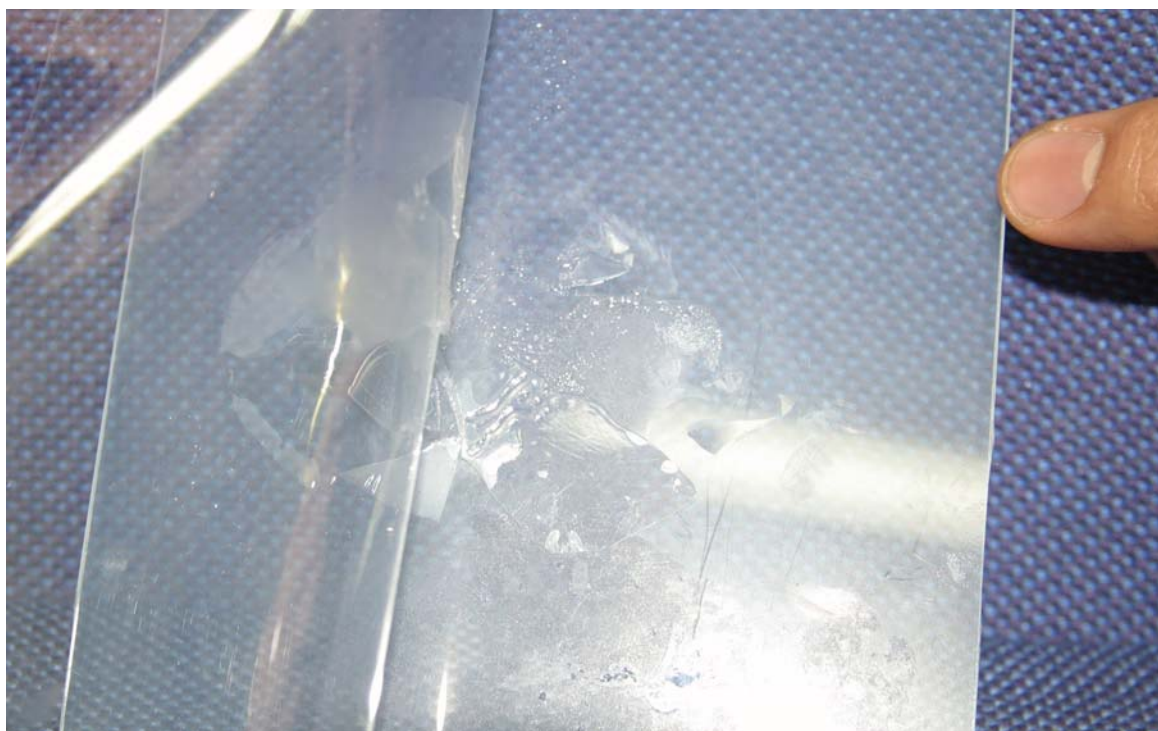
【圖 3-16】曝光一秒之 UV 膠膜與壓克力分離照片 1
