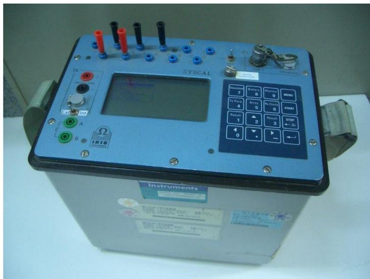
圖 3- 13 地電阻探測儀-SYSCAL PRO Switch 48
