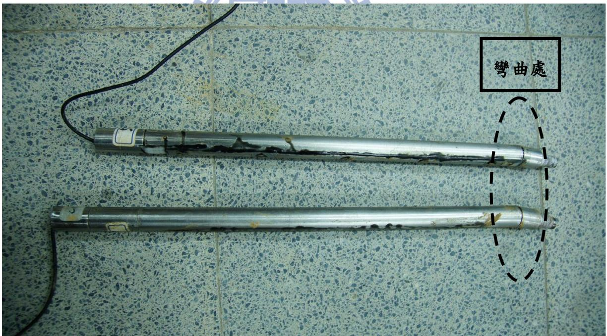
圖 4-34 感測器彎曲處
