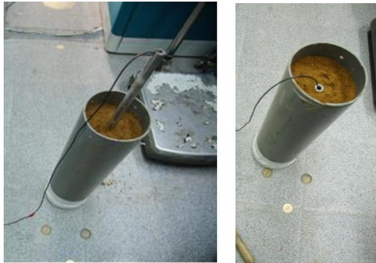
圖 3- 11 率定土樣導電度、土壤介電度與體積含水量
