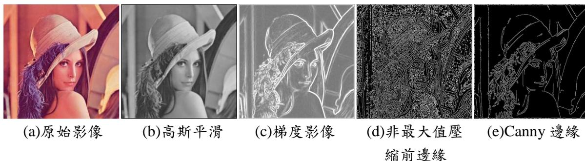
圖 3-1、Canny 各步驟示意圖。
