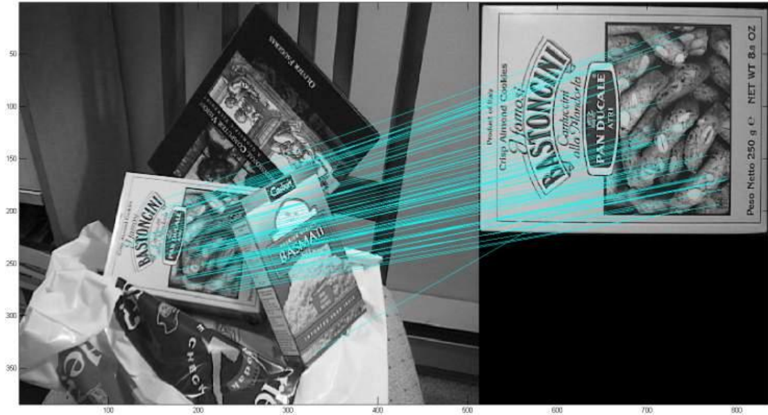
圖 2-3、以 SIFT 針對具有尺度縮放、仿射變形、旋轉情況的影像匹配
