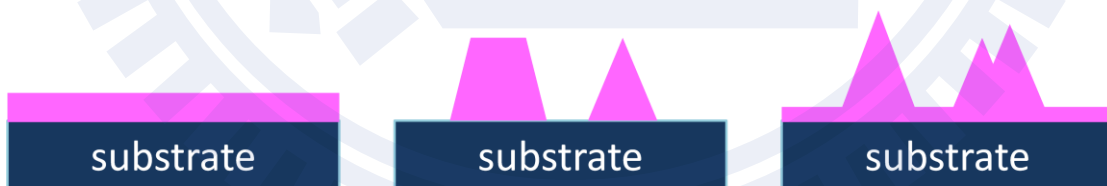
圖 5. 三種成長模式：(a) Layer-by-layer Mode、(b) Island Mode、(c) Stranski-Krastanov Mode。
