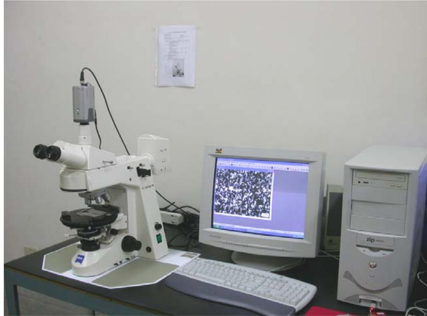
圖 2.10 Axioskop 40 Pol 偏光顯微鏡系統
