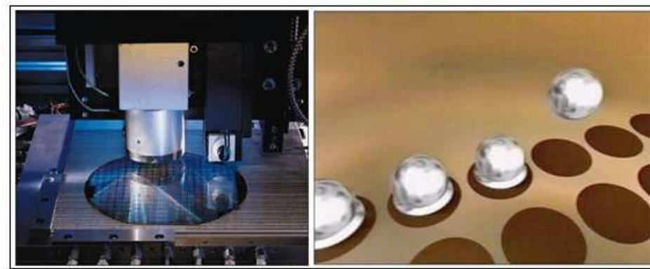
圖 2.13：熔錫噴射製程的設備和示意圖。[29]
