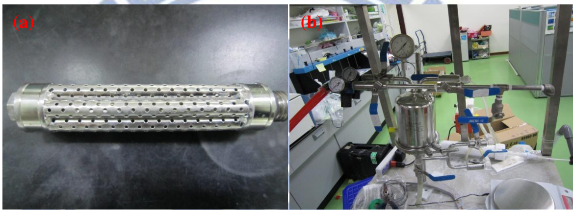
圖 3-4 實驗設備(a)截流式薄膜濾芯、(b)截流式薄膜測試模組
