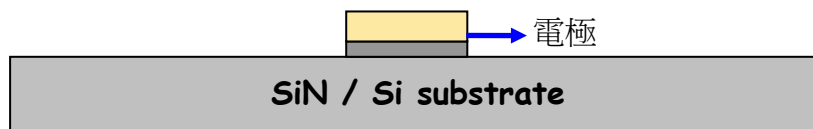
圖 3.7 晶圓經過舉離過程洗除光阻後，剩下表面設計圖案的金屬電極。
