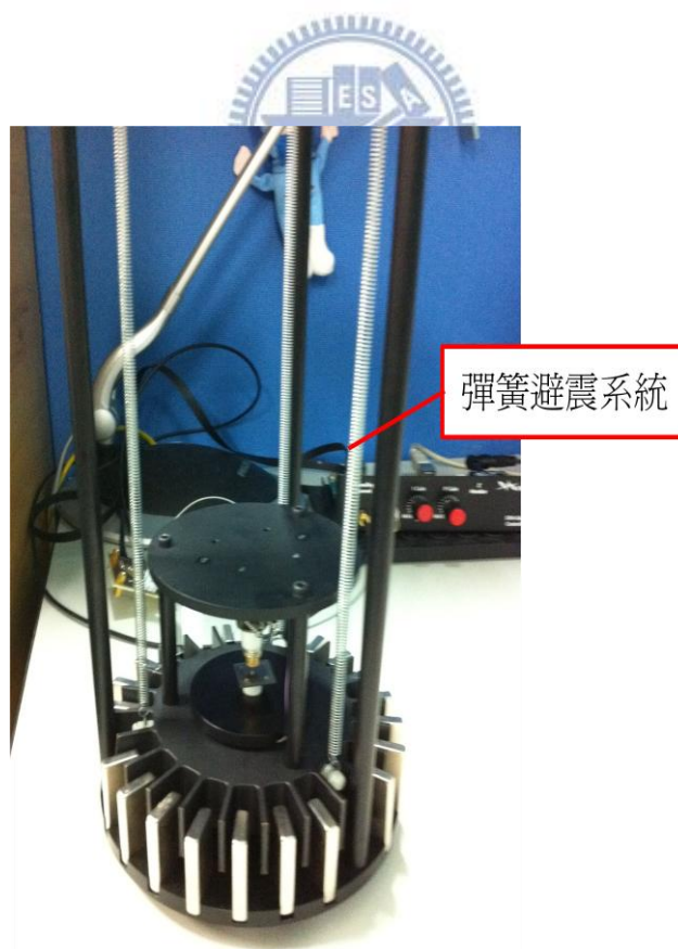
圖 3.14 彈簧懸吊系統位置與 STM 主體懸吊置於 eddy current 阻尼陣列中，平衡時磁鐵應在兩個鰭片之間。
