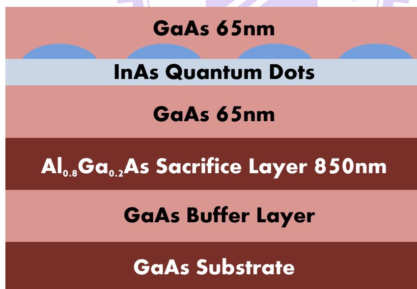
【圖 3-1】 砷化銦量子點樣品結構圖。
