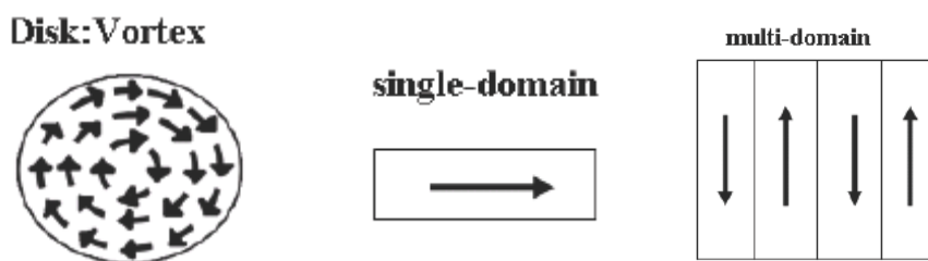
圖 2-2 不同磁區的的結構示意圖，從左到右依序為漩渦狀(vortex)、單磁區(single domain)、多磁區(multidomain)。
