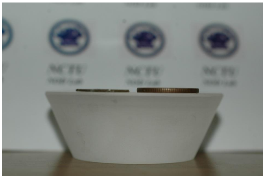
圖 5-3 800um 之氮化鎵厚膜與一元硬幣之厚度比較圖
