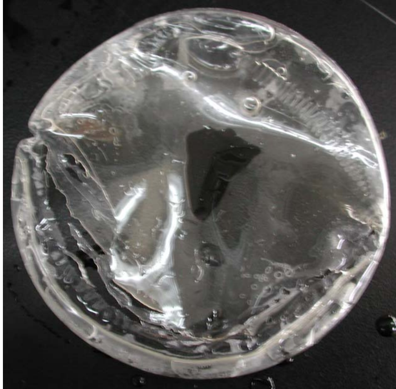
圖 3-3 成型失敗破裂之高分子薄膜
