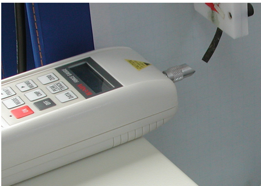
圖 4-16 Force Gauge 應保持水平穩定放置
