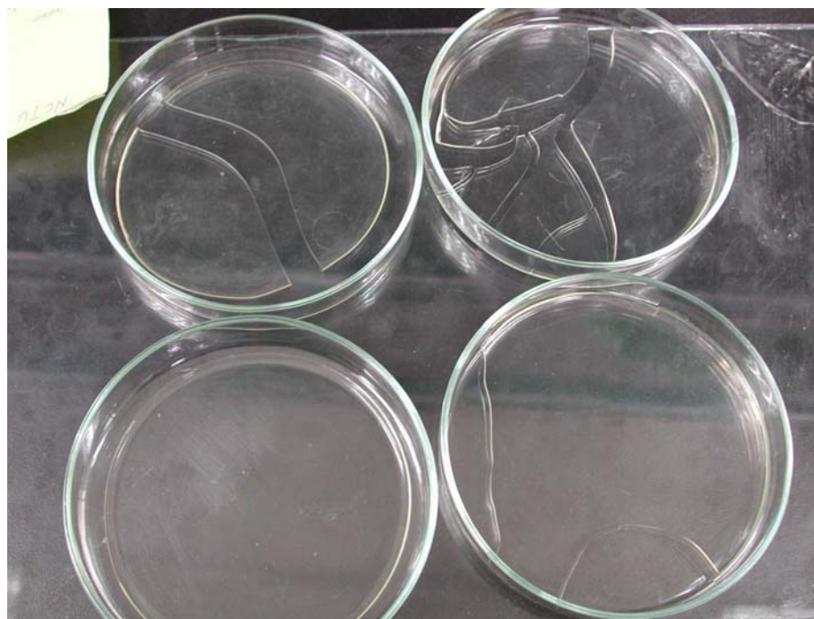
圖 3-1 未添加 DMF 所成型之薄膜
