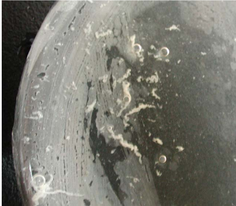
圖 3-2 成型後的高分子薄膜中出現白色之沉澱物
