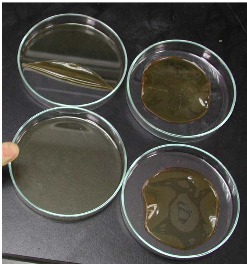
圖 3-4 熱處理後之高分子薄膜
