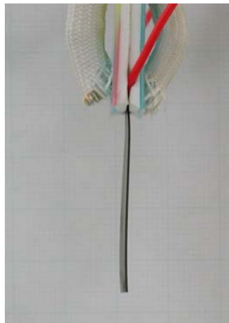
圖 4-8 被具有電極的夾具夾持的 IPMC
