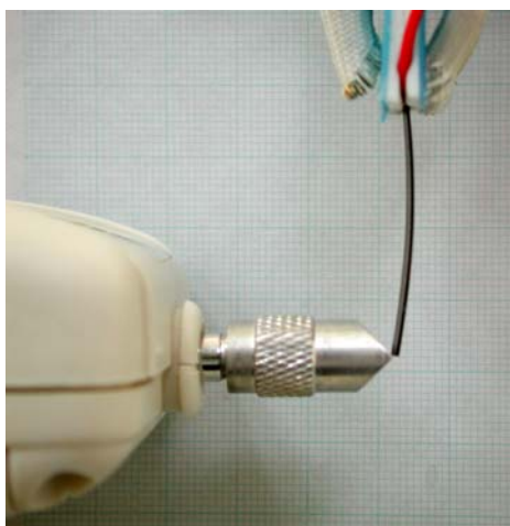
圖 4-15 Force Gauge 之探針將 IPMC 頂回初始位置
