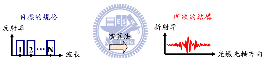
圖(3.1) 多通道 FBG 設計示意圖
