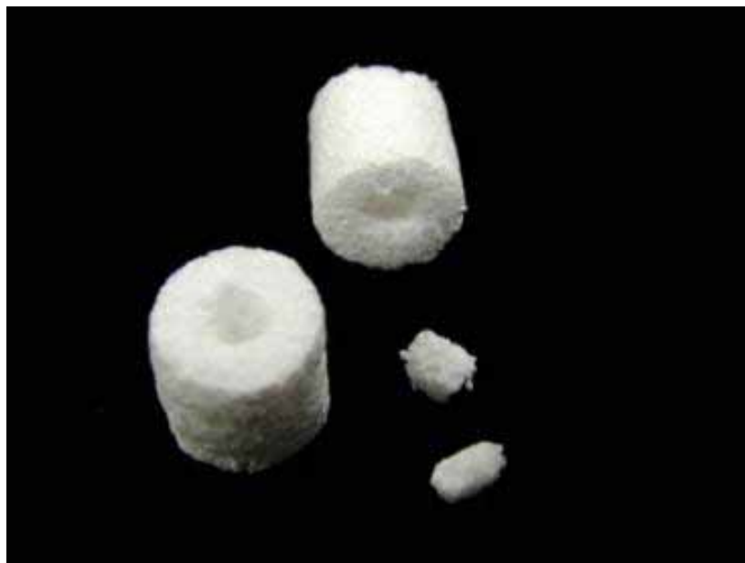
圖 3-1 PLGA 多孔隙中空載體實體攝影
