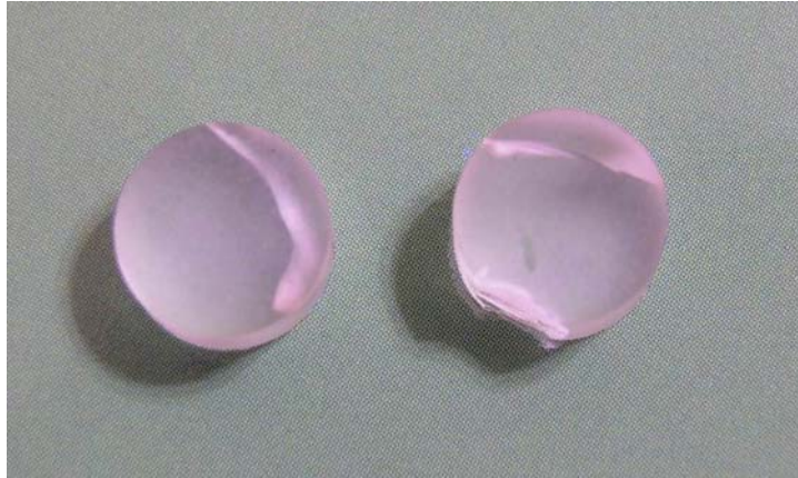
圖 4-7 玻璃毛胚倒角過淺導致邊角崩裂
