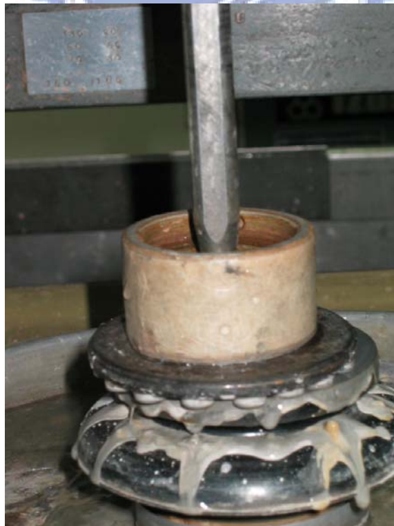
圖 4-11 玻璃磨砂過程圖
