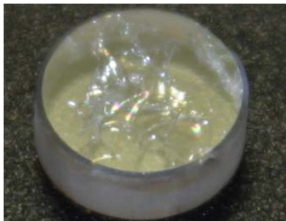
圖 5-5 上、下模仁溫差造成玻璃內部破裂圖
