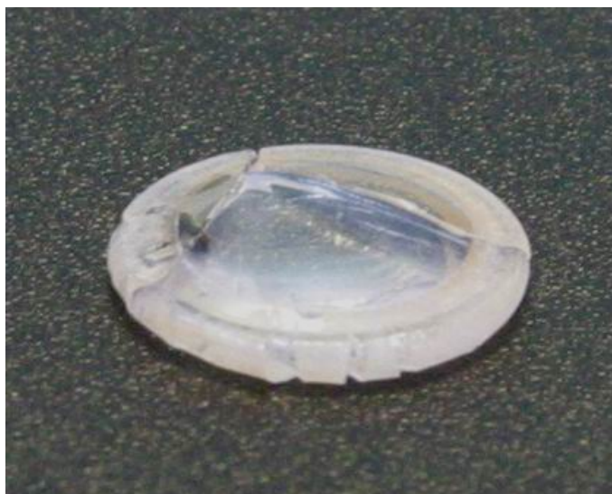
圖 5-7 球面透鏡初步熱壓結果外觀圖
