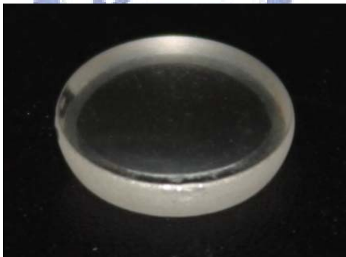
圖 5-26 玻璃球面透鏡壓印成品外觀圖
