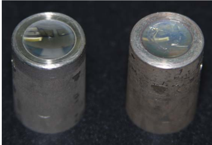
圖 5-28 無電解鎳模仁未壓印前（左）、壓印後（右）
