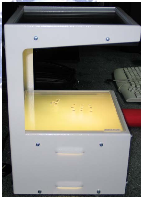
圖 6-13 本實驗所使用之光彈性實驗儀外觀圖
