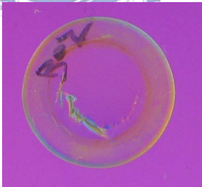
圖 6-16 變形量較大之殘留應力檢測結果
