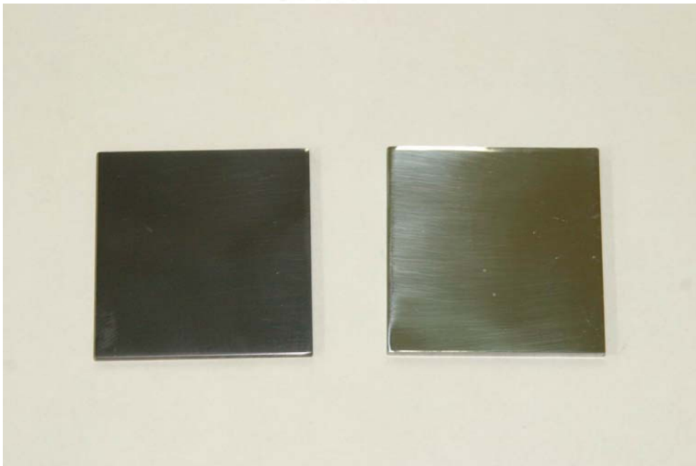
圖 3-4 鏡面板表層鍍 TiAlN (右) 與鏡面板 (左) 外觀圖
