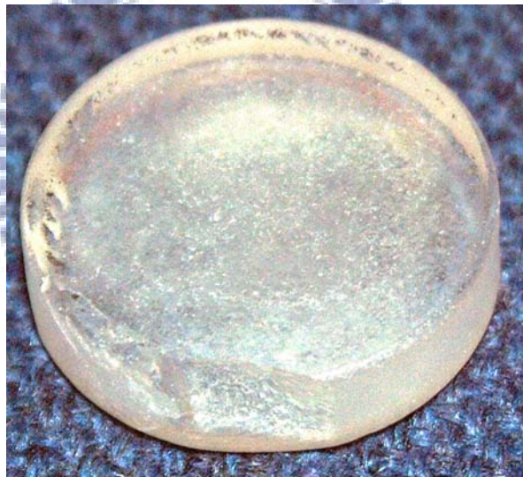
圖 3-11 FCD1 光學玻璃邊緣崩裂圖
