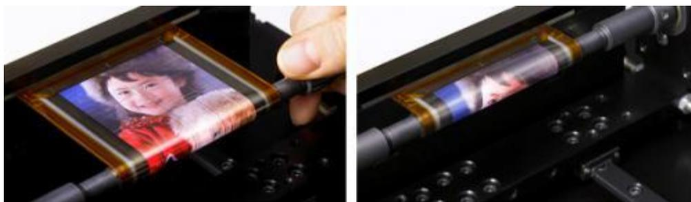
圖 1-4、Sony 在 SID 2010 所發表的“Rollable OLED”面板
