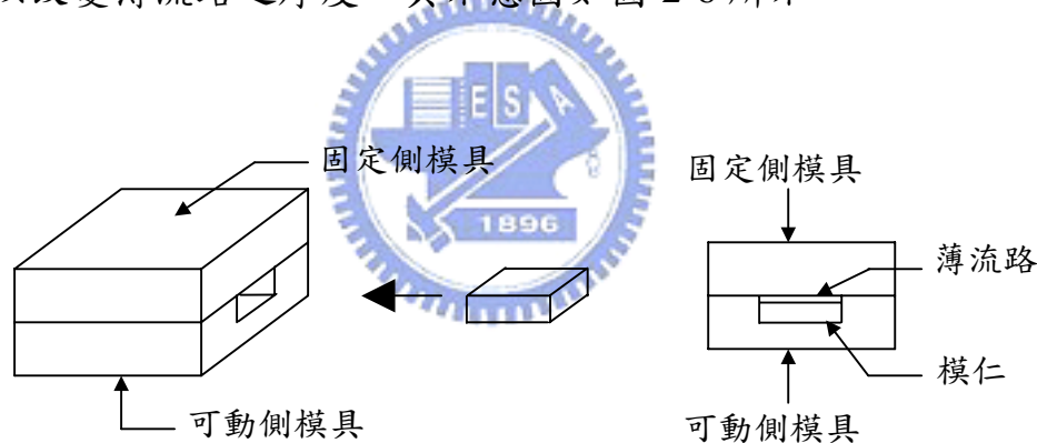
圖 2-6 模仁與薄流路示意圖
