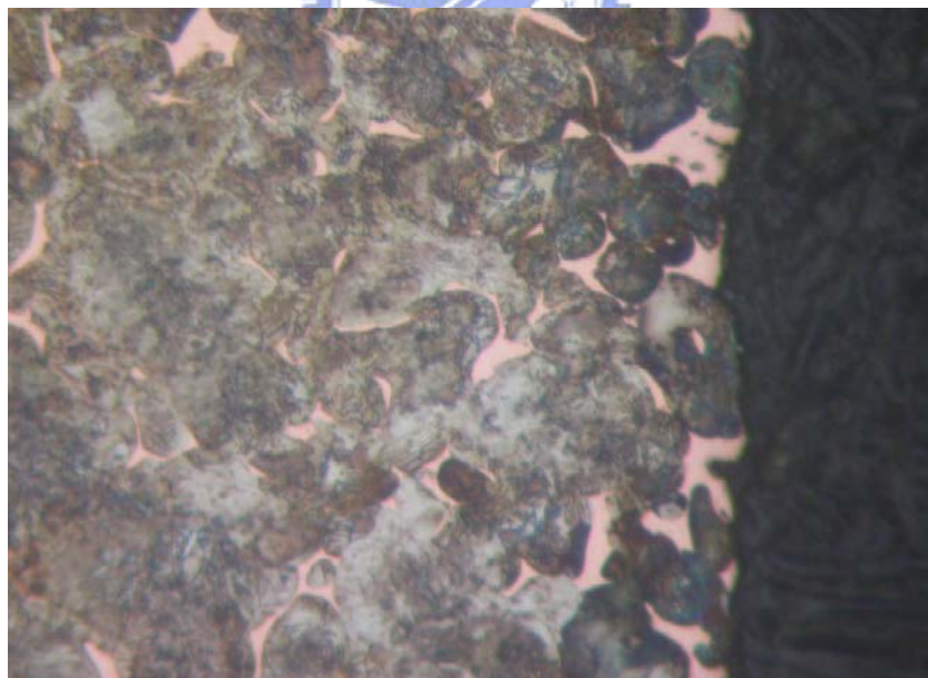
圖 7.15(b) A 粉末製成齒輪經銅熔滲後之金相圖 (齒部)
