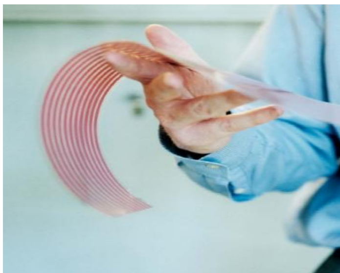
圖二、美國 Konarka 公司展示的可撓式有機太陽能電池 8
