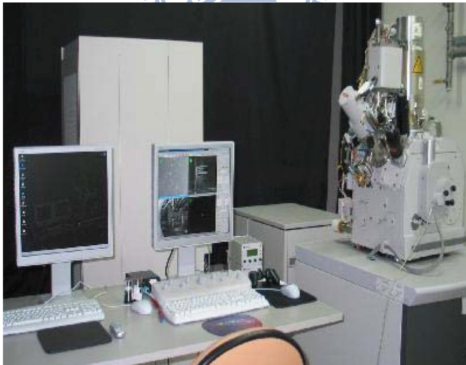
圖 3.16 FIB(Focused Ion Beam)鍍閘極金屬
