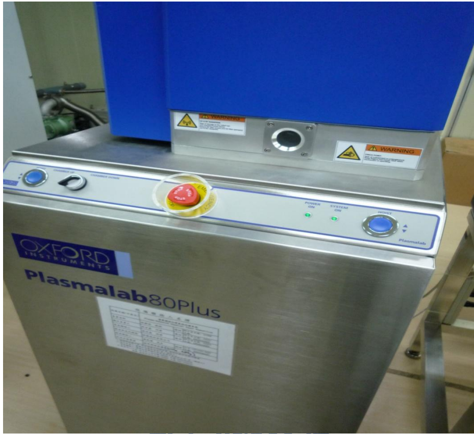
圖 3.13 交通大學奈米科技中心 PECVD 系統
