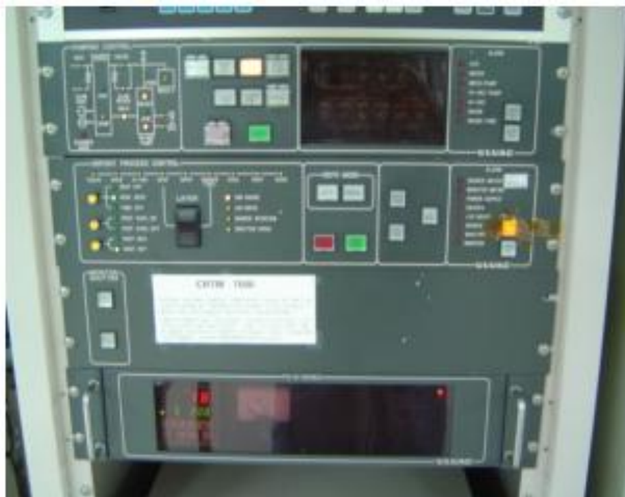
圖 3.3 電子槍蒸鍍系統操作介面
