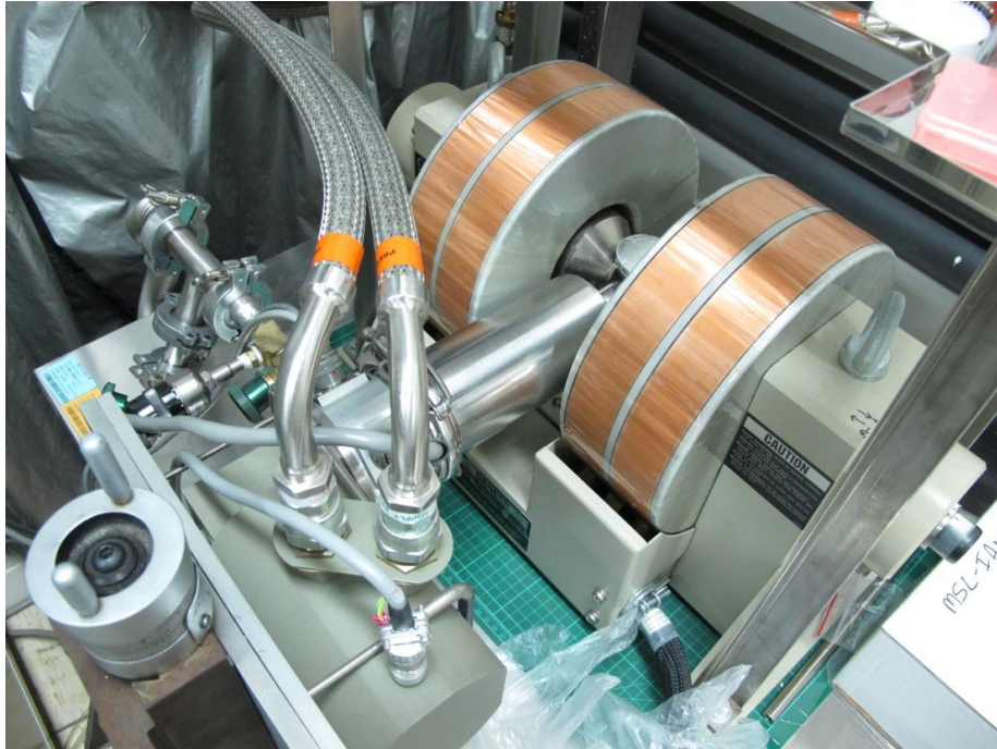
圖 3.9 霍爾量測機台(左右兩個圓圈提供磁場)
