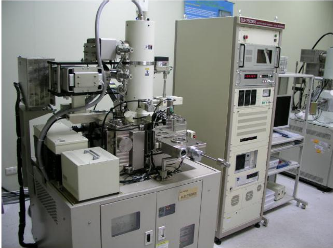
圖 2.4 電子束微影系統(ELS-7500EX)
