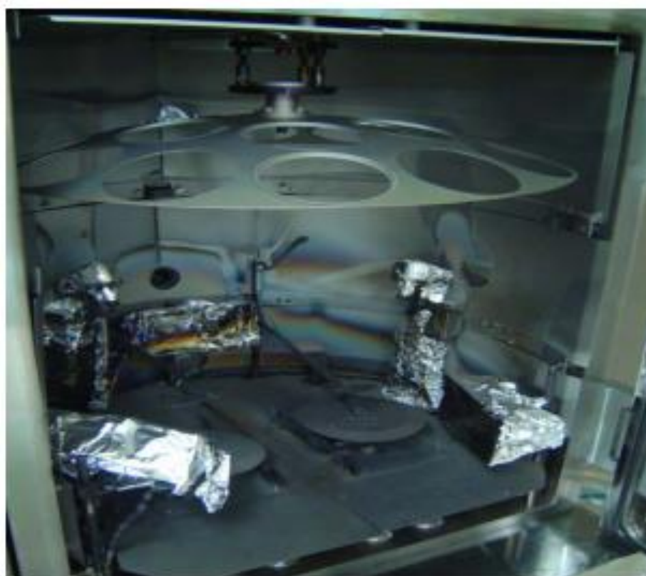
圖 3.4 電子槍蒸鍍系統腔體內部
