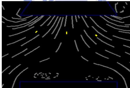
圖 4-15 流場中固體粒子與氣流之運動情形 1
