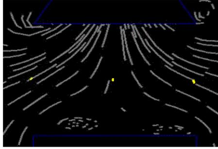
圖 4-13 流場中固體粒子與氣流之運動情形 1
