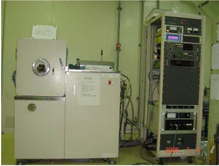
圖3-8 電子槍蒸鍍系統
