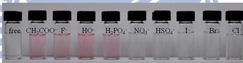
圖五十二、化合物 30 (25 \mu\text{M} ) 在 \text{CH}_3\text{CN}/\text{CHCl}_3 (v/v, 99:1) 極性混溶劑中分別加入9種各為100當量之四丁基胺鹽陰離子( \text{CH}_3\text{COO}^- 、 \text{H}_2\text{PO}_4^- 、 \text{HSO}_4^- 、 \text{NO}_3^- 、 \text{F}^- 、 \text{Cl}^- 、 \text{Br}^- 、 \text{I}^- 、 \text{HO}^- )之溶液顏色。
