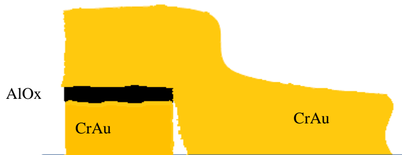
圖 4-3-1 Cr/Au/AlOx/Cr/Au 穿隧接點的側視圖。
